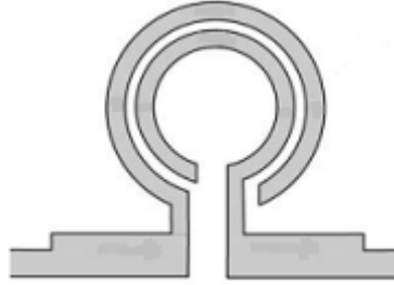
Fig. I. 11. Résonateurs à anneaux fendus ouvert (OSRR).
