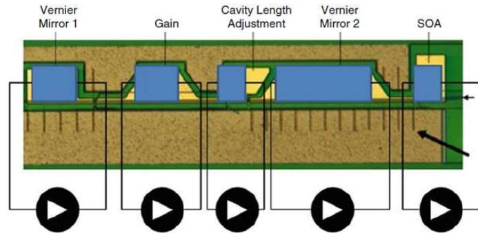
**Figure 3.2:** Coupe transversale du laser SG-DBR, chaque section est pilotée par injection de courant. Les deux miroirs de Bragg ont des périodes légèrement différentes afin d'accorder le laser sur une grande bande spectrale en utilisant l'effet Vernier [116].
