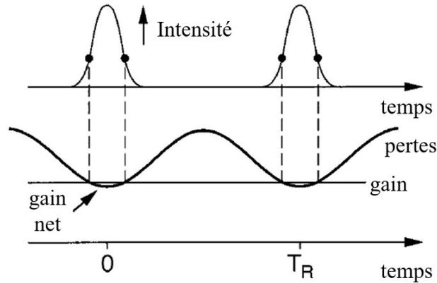
**Figure 4.2:** Le blocage de modes actif dans le temps. La génération des impulsions dépend du gain et de la modulation des pertes. [138]
