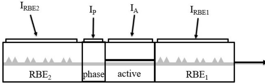
Figure 1.16: Schéma du laser SG-DBR à 4 sections.
