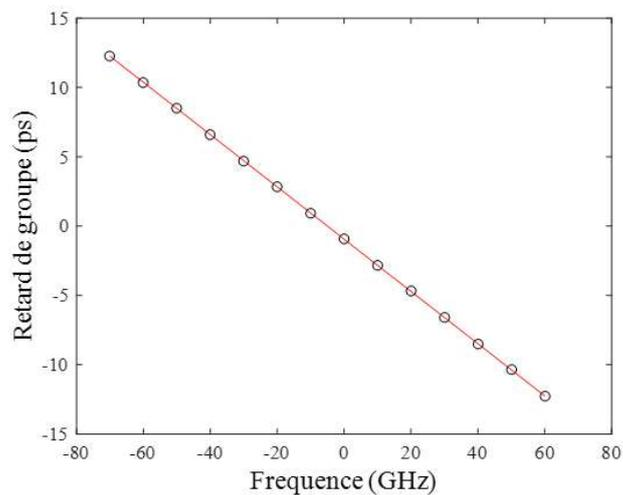
**Figure 5.7:** Le retard de groupe. (Rouge) courbe théorique calculée à partir de  $30 \text{ ps}^2$  de dispersion quadratique. (Cercles noirs) valeurs mesurées en utilisant le laser accordable.
