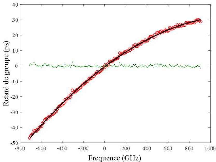
**Figure 5.28:** Le retard de groupe. (Cercles rouges) valeurs mesurées en utilisant le SG-DBR. (Courbe noire) courbe théorique calculée à partir de  $8.23 \text{ ps}^2$  de dispersion quadratique et  $1.01 \text{ ps}^3$  de dispersion cubique. (Points verts) l'erreur du retard de groupe ( $< 2 \text{ ps}$ ).
