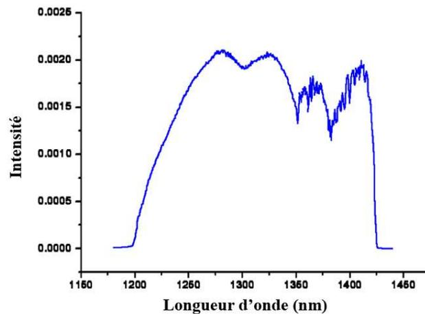
Figure 1.27: Spectre optique du laser FDML [84].
