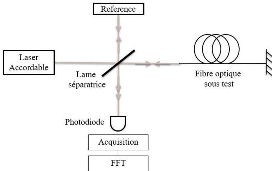
Figure 1.8: Schéma du montage de l'OFDR
