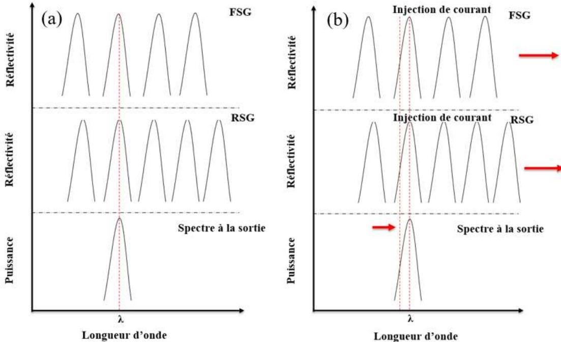
**Figure 2.15:** (a) La configuration initiale des deux miroirs FSG et RSG. (b) L'injection du courant simultanément dans le FSG et le RSG ce qui engendre le décalage des pics de réflexion des deux miroirs. La longueur d'onde de sortie est accordée en continu.
