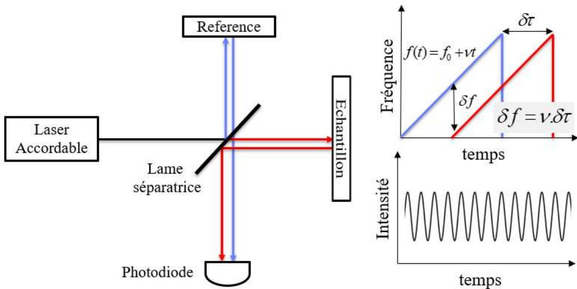
Figure 1.6: Schéma du montage de la technique SS-OCT.
