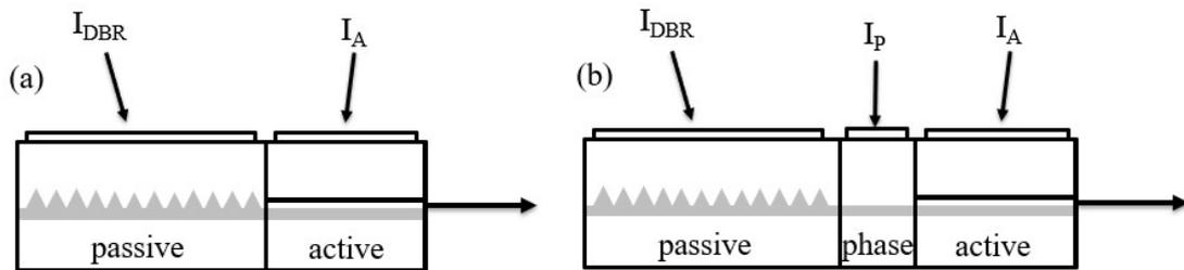
**Figure 1.15:** (a) Schéma d'un laser DBR à 2 sections. (b) Schéma d'un laser DBR à 3 sections.
