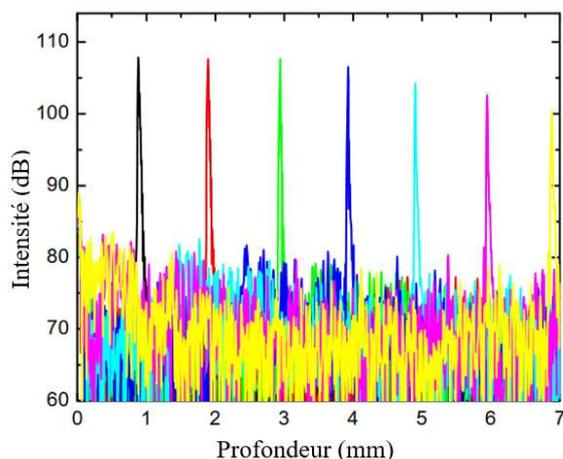
**Figure 1.28:** La mesure du roll-off du laser FDML [82].
