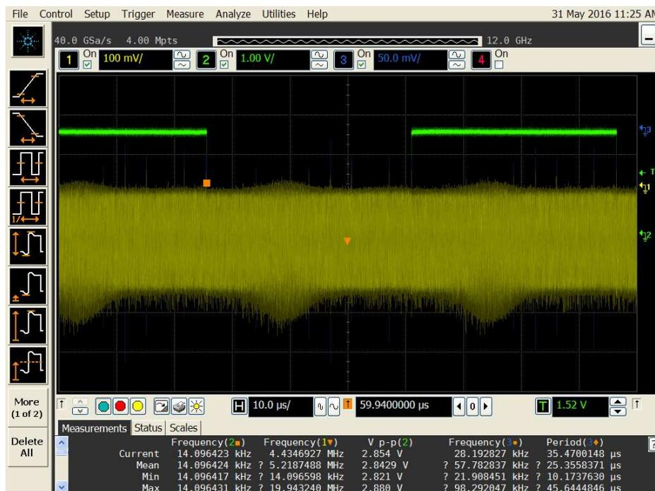
**Figure 5.9:** (Jaune) le signal de battement entre le SG-DBR et le TMLL-1550. (Vert) l'horloge du SG-DBR. Chaque période représente un balayage complet. Echelle du temps 10 µs/div.
