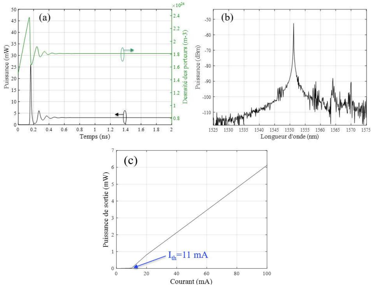
**Figure 2.12:** (a) La simulation de la réponse transitoire du SG-DBR. (Vert) la densité des porteurs. (Noir) la puissance de sortie. (b) Le spectre optique à la sortie du laser. La longueur d'onde sélectionnée est à 1551 nm avec un SMSR > 30 dB. (c) La puissance de sortie en fonction du courant injecté dans la zone active.
