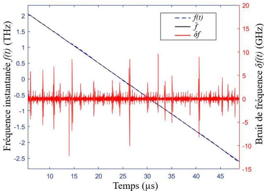
**Figure 3.8:** (Bleu pointillé) La fréquence instantanée  $f(t)$ . (Noir) la fréquence moyenne de balayage  $\tilde{f}$ . (Rouge) la fluctuation de la fréquence instantanée.
