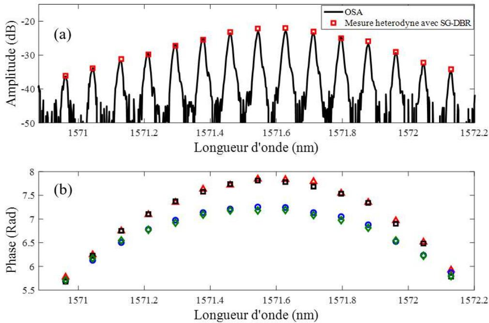
**Figure 5.19:** (a) (noir) le spectre optique du laser à blocage de mode. (Rouge) l'amplitude mesurée. (b) (Triangles rouges) (carrés noirs) la phase spectrale du QD-MLL filtré mesurée en utilisant respectivement le SG-DBR et la stepped-heterodyne. (Cercles bleus) (losanges verts) la phase spectrale du QD-MLL filtré après 100m de fibre monomode, mesurée en utilisant respectivement le SG-DBR et la stepped-heterodyne.
