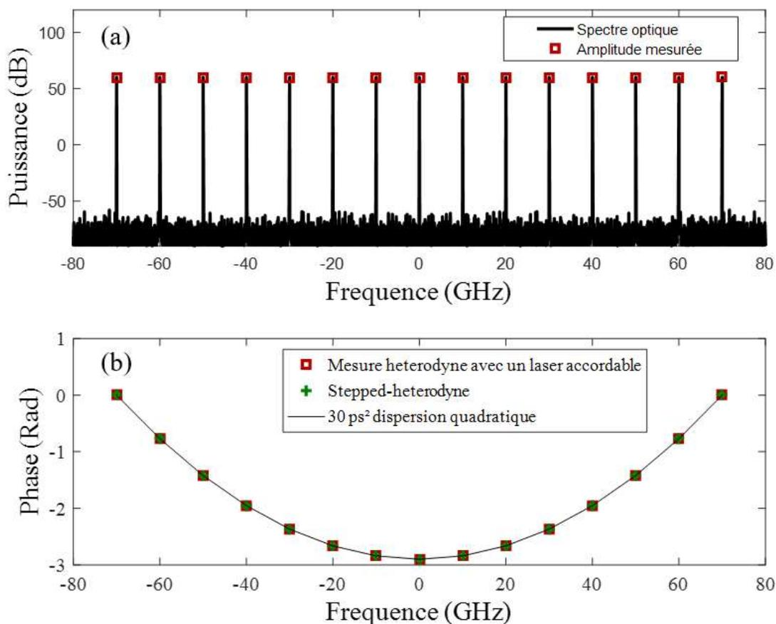
**Figure 5.5:** (a) (noir) le spectre optique du laser à blocage de mode. (Rouge) l'amplitude mesurée. (b) (rouge) la phase spectrale mesurée en utilisant le laser accordable. (Vert) la phase spectrale mesurée avec la technique stepped-heterodyne. (Noir) la courbe de 30 ps<sup>2</sup> de dispersion quadratique.
