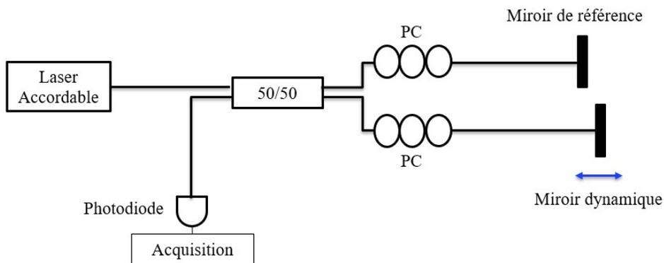
**Figure 3.14:** Schéma du montage destiné à mesurer le roll-off. PC : contrôleurs de polarisations. Le miroir de référence est fixé tandis que le deuxième miroir est translaté afin de varier la différence de marche optique.
