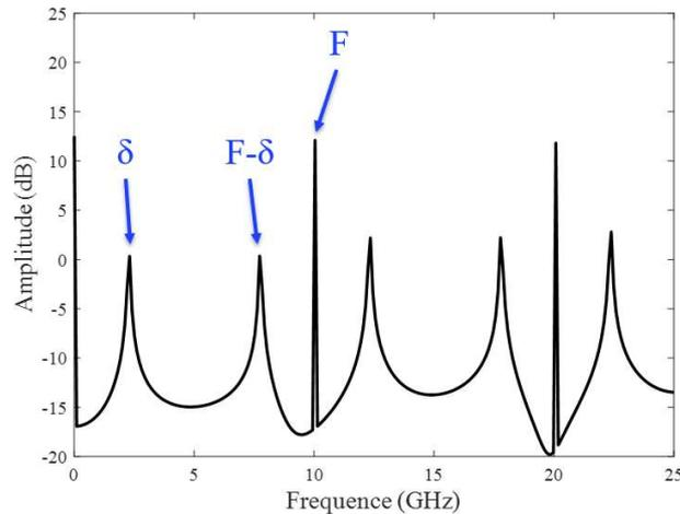
**Figure 5.4:** Le spectre RF du signal de battement entre le laser accordable et deux modes adjacents.  $\delta$ ,  $F-\delta$  sont respectivement les fréquences de battement avec le premier et le second mode,  $F$  la fréquence de répétition.
