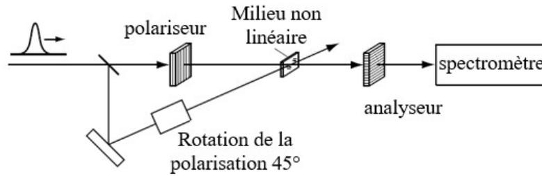
**Figure 4.5:** Schéma du montage de la PG-FROG. [152]
