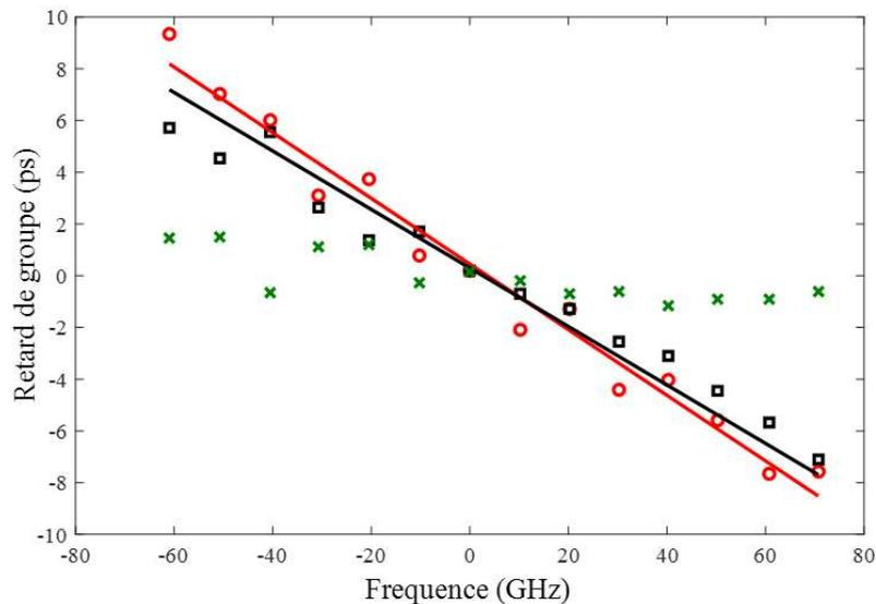
**Figure 5.21:** Le retard de groupe. (Cercles rouges) valeurs mesurées en utilisant le SG-DBR. (Courbe rouge) régression linéaire. (Courbe noire) courbe théorique calculée pour une dispersion introduite par 100m de fibre monomode. (Carrés noirs) valeurs mesurées après 100m de fibre monomode. (Vert) l'erreur du retard de groupe (<1.5ps).
