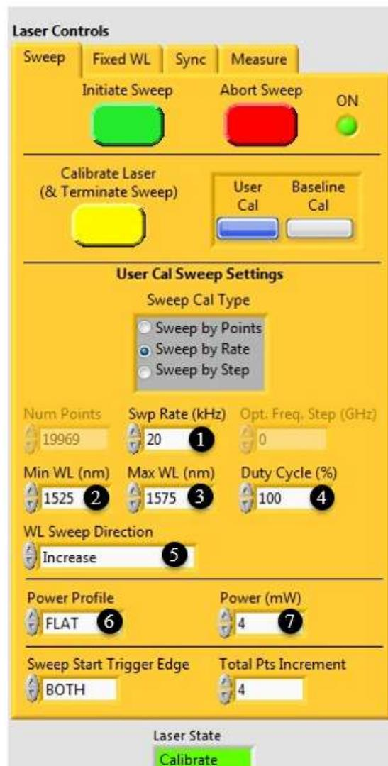
**Figure 3.3:** Interface d'utilisateur du laser SG-DBR de la compagnie insight Photonics Solutions Inc. (1) La fréquence de balayage entre 20 et 300 kHz. (2) La longueur d'onde minimale. (3) La longueur d'onde maximale. (4) Le cycle de travail. (5) La direction de balayage. (6) Le profil de la puissance. (7) La puissance de sortie.
