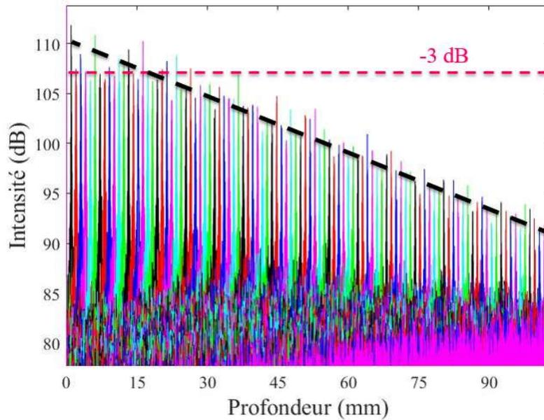
**Figure 3.15:** Résultat de mesure du roll-off. (Noir) la pente du roll-off. (Rouge) le seuil -3 dB utilisé pour calculer la longueur de cohérence. Le SG-DBR est accordé sur 50 nm avec une fréquence de balayage de 20 kHz. La longueur de cohérence mesurée est de 18 mm.
