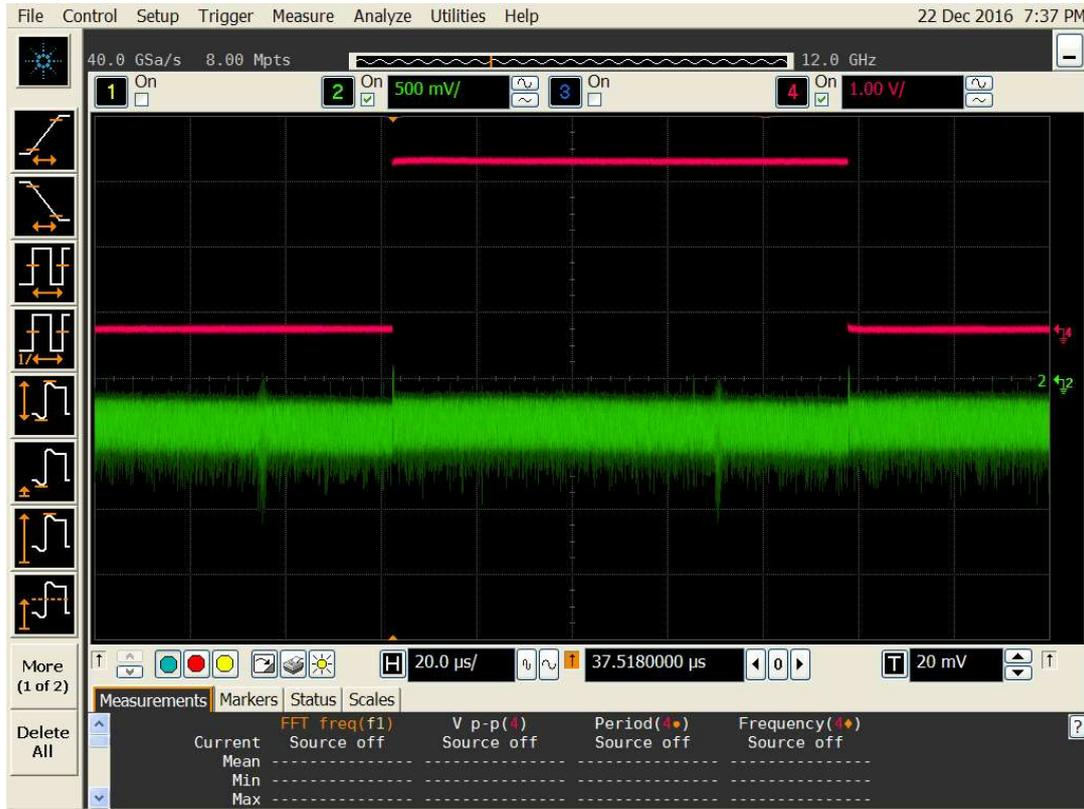
**Figure 5.16:** (Vert) le signal de battement entre le SG-DBR et le QD-MLL filtré. (Rouge) l'horloge du SG-DBR. Echelle du temps 20  $\mu$ s/div.
