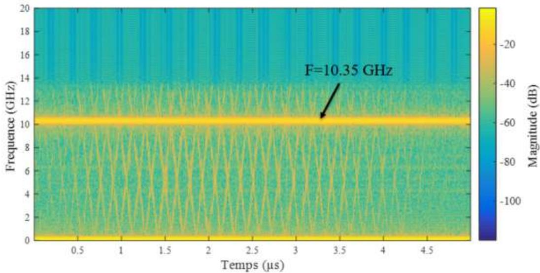
Figure 5.10: Le spectrogramme du signal de battement calculé avec la STFT.
