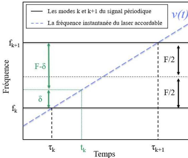
**Figure 5.2:** La représentation temps-fréquence du battement entre le laser accordable et l'objet sous test. (Noir) les modes  $k$  et  $k+1$  du signal périodique. (Bleu pointillé) la fréquence instantanée du laser accordable. (Vert pointillé) filtrage du signal de battement à l'instant  $t_k$  correspondant à une fréquence instantanée du laser accordable positionnée entre les deux modes  $k$  et  $k+1$  avec un décalage  $\delta$  inférieur à  $F/2$ .
