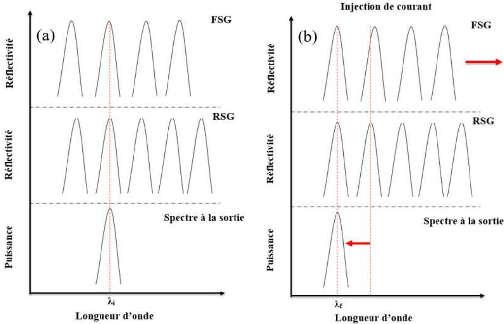
**Figure 2.13:** (a) La configuration initiale des deux miroirs FSG et RSG. (b) L'injection du courant dans le FSG ce qui engendre le décalage des pics de réflexion de ce dernier. Désormais les deux miroirs coïncident en une nouvelle longueur d'onde. La longueur d'onde de sortie est accordée en saut de mode.
