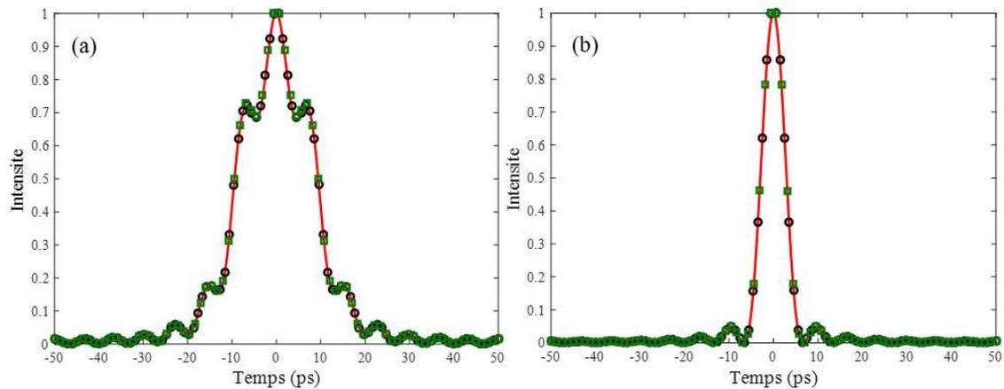
**Figure 5.6:** (a) L'impulsion mesurée directement à la sortie du laser. (b) L'impulsion mesurée après la compensation de la dispersion. (Rouge) l'impulsion générée par le laser à blocage de modes. (Cercles noirs) l'impulsion mesurée en utilisant le laser accordable. (Carrés verts) L'impulsion mesurée avec la technique stepped-heterodyne.
