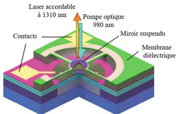
Figure 1.11: Schéma 3D d'un laser accordable MEMS-VCSEL à 1310 nm [63].
