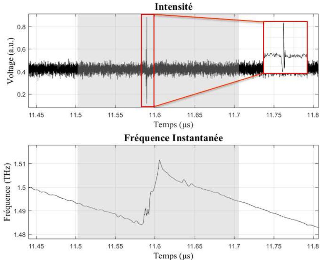
**Figure 3.7:** Zoom sur l'amplitude et la fréquence instantanée du signal lors d'un saut de mode. (Gris) la partie du signal inexploitable qui sera filtrée. (Rouge) les oscillations de relaxations après la reconfiguration des miroirs de Bragg.
