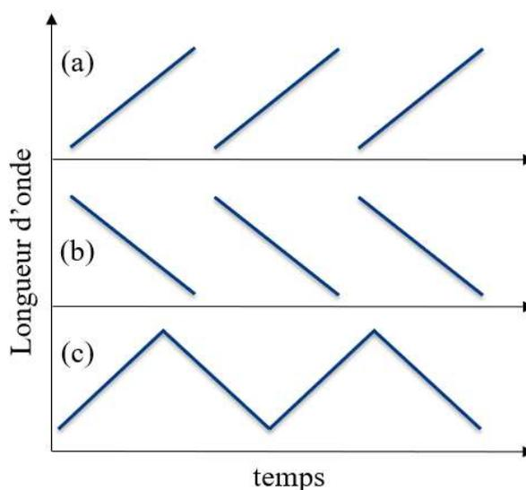
**Figure 1.3:** La direction de balayage du laser accordable ; (a) direction directe, (b) direction inverse et (c) les deux directions.
