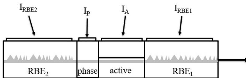
Figure 1.18: Schéma du laser SSG-DBR à 4 sections.
