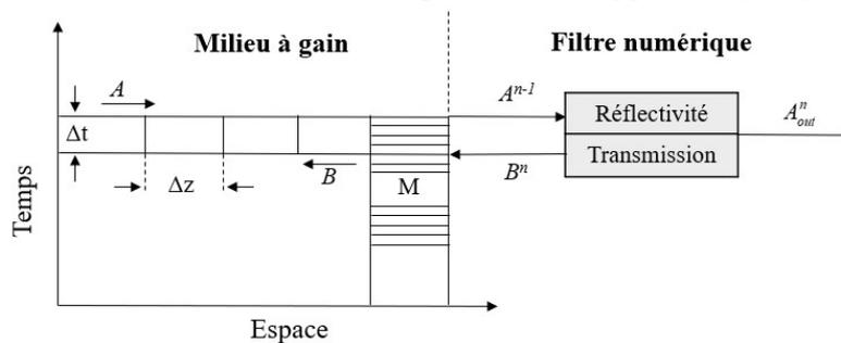
**Figure 2.10:** Schéma illustrant l'approche du filtre numérique [101].
