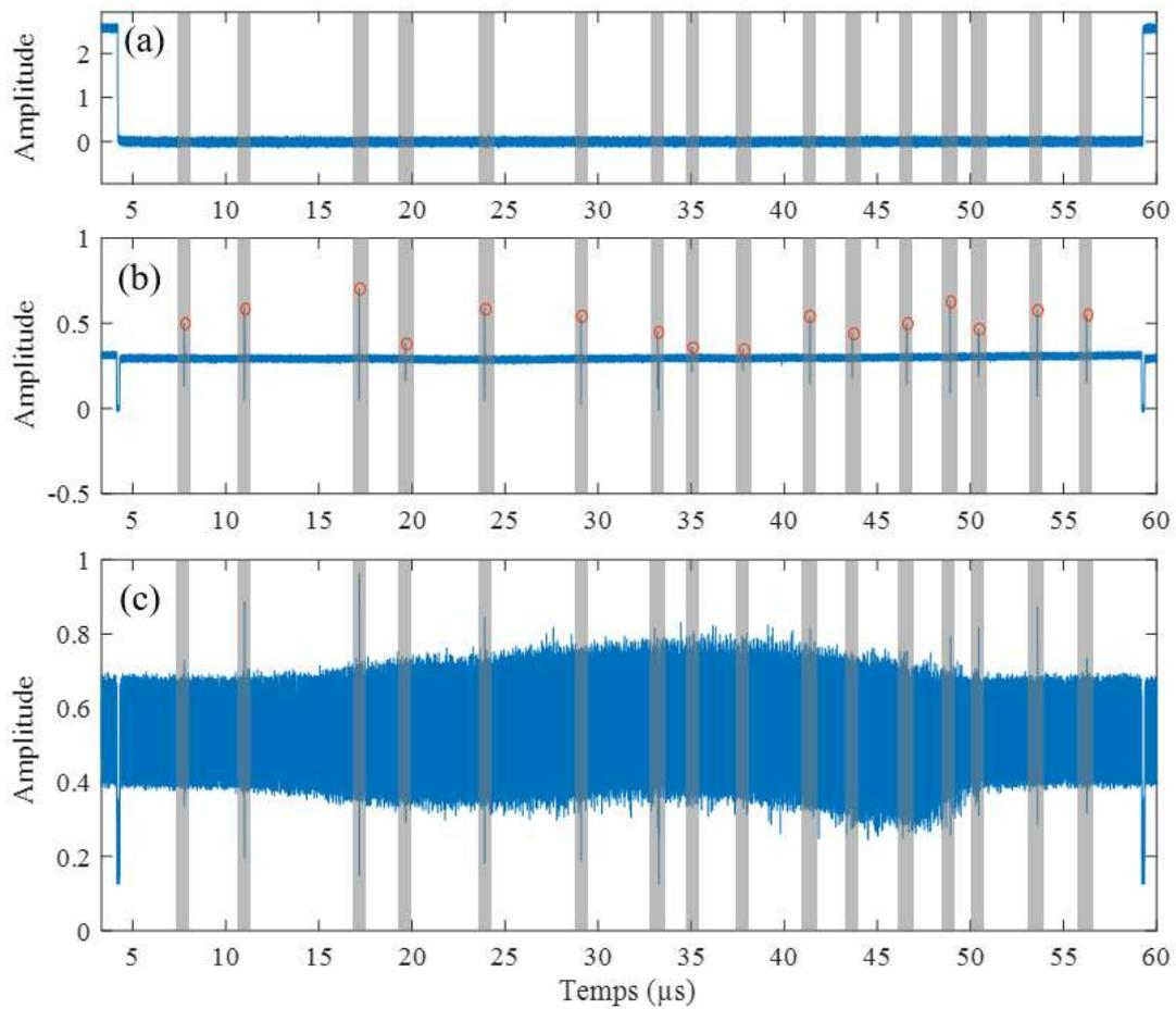
**Figure 5.24:** (a) L'horloge de synchronisation du SG-DBR. (b) le signal de référence du SG-DBR. (c) le signal de battement entre le SG-DBR et le QD-MLL. (Cercles rouges) Les sauts de modes. (Gris) les zones à filtrer.
