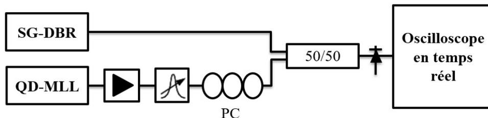
**Figure 5.15:** Montage expérimental de la mesure hétérodyne utilisant un SG-DBR.
