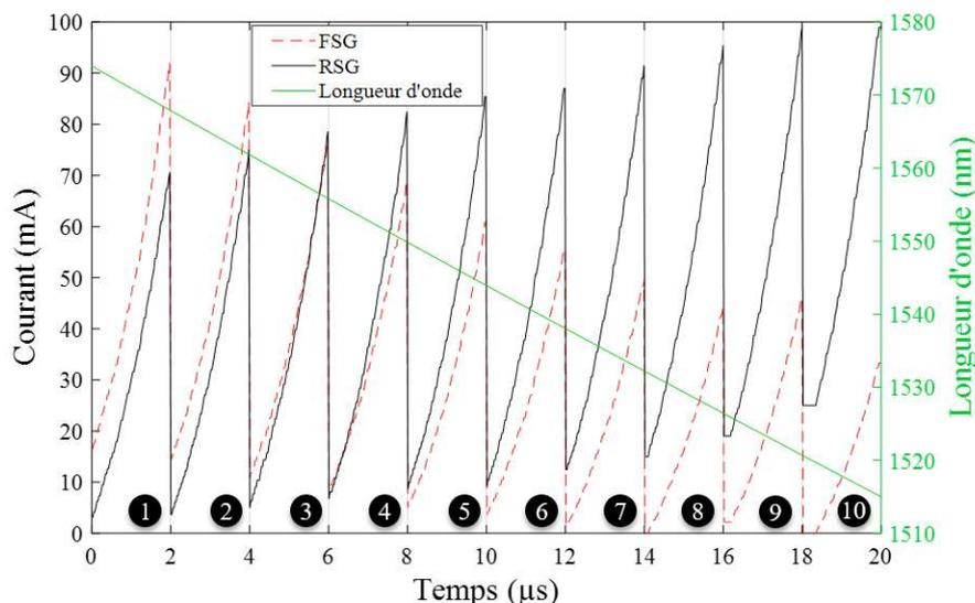
**Figure 2.18:** L'accord linéaire du SG-DBR de manière quasi-continue. (Vert) L'évolution de la longueur d'onde de sortie dans le temps. (Rouge pointillé) La variation dans le temps du courant injecté dans le FSG. (Noir) dans le RSG.
