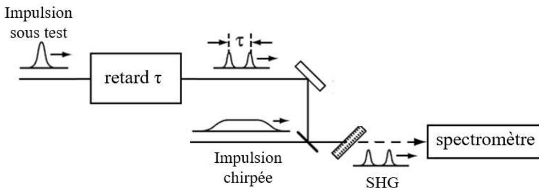
Figure 4.8: Schéma du montage de la méthode SPIDER. [152]
