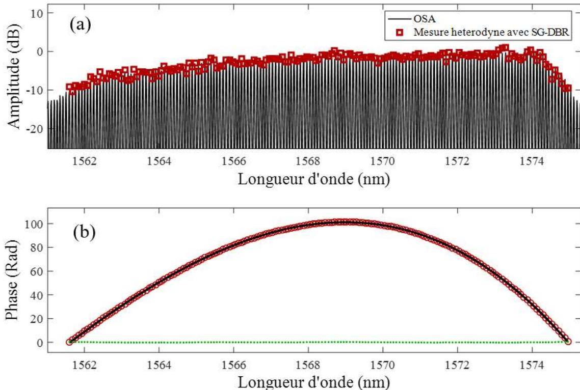
**Figure 5.26:** (a) (noir) le spectre optique du laser à blocage de mode. (Rouge) l'amplitude mesurée. (b) (cercles rouges) la phase spectrale mesurée du QD-MLL avant la compensation de dispersion. (Noir) la courbe de  $8.23 \text{ ps}^2$  de dispersion quadratique et  $1.01 \text{ ps}^3$  de dispersion cubique. (Points verts) le profil de phase du QD-MLL après la compensation de la dispersion.
