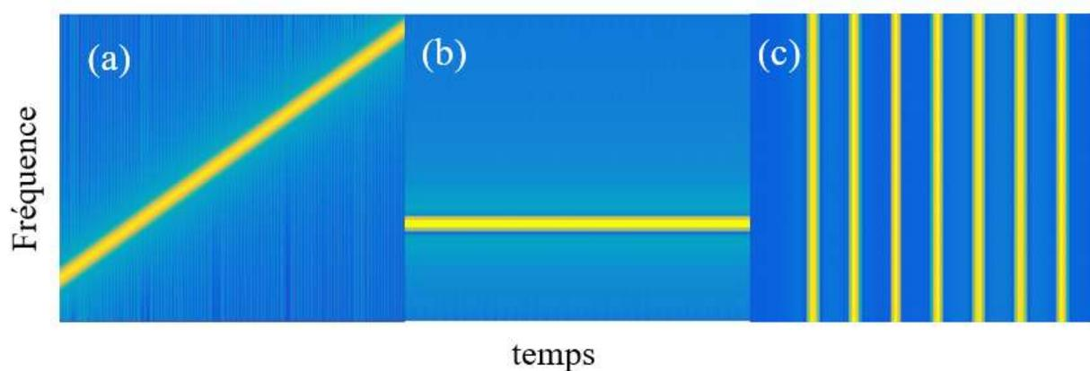
**Figure 1.2:** Représentation temps-fréquence des lasers, (a) laser accordable, (b) laser monomode et (c) laser pulsé.
