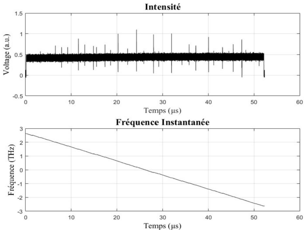
**Figure 3.6:** Reconstruction du champ électrique  $E$  du SG-DBR pour un balayage sur 50 nm autour de 1550 nm avec une fréquence de balayage de 20 kHz. (Haut) intensité  $R(t)$  du champ électrique. (Bas) la fréquence instantanée du laser  $f(t)$ .
