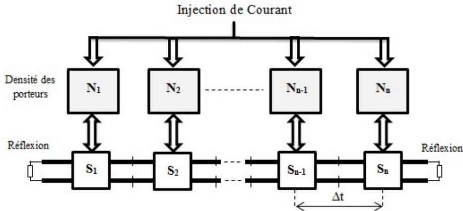
Figure 2.7: Schéma du modèle des lignes de transmission.
