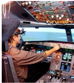
FIGURE 3.3 – L’attention des pilotes d’avion peut être étudiée en utilisant le système de suivi du regard [31]
