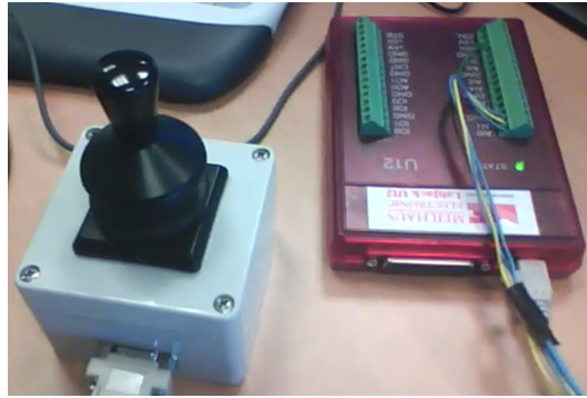
FIGURE 1.36 – Simulateur de conduite ViEW : Organe de commande (Joystick Penny & Giles et module d’acquisition Labjack U12)
