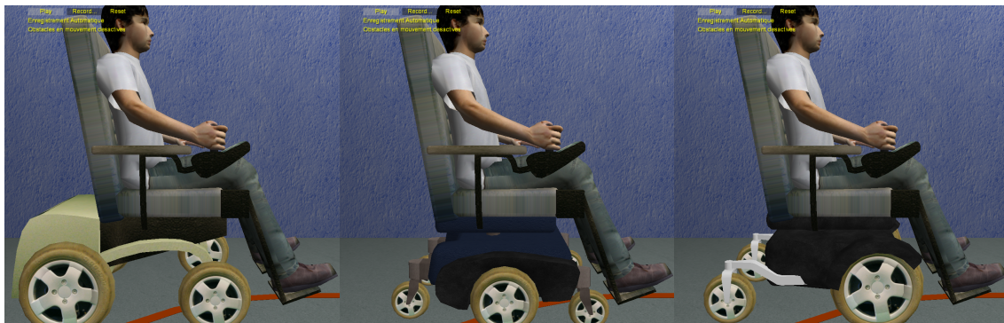
FIGURE 1.37 – Simulateur de conduite ViEW : architectures de fauteuil (propulsion, centrale et traction)
