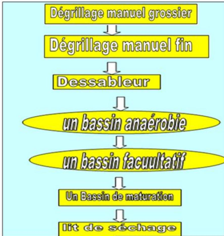
Figure 26 : Schéma du lagunage de Sidi Safi
