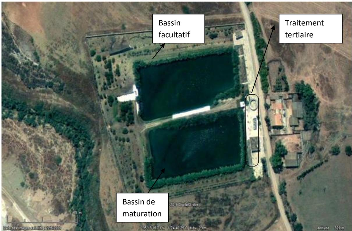
**Figure 18 : Vue dessus (Google Earth) de la station de l'Amir Ebdel Kader (Chachoua ,2016)**
