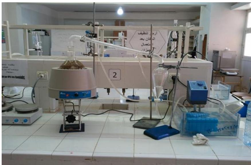
**Figure 23** : Montage hydrodistillation.
