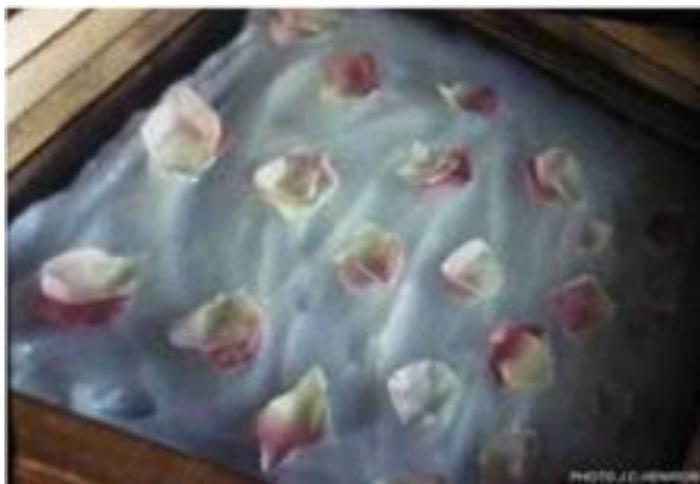
**Figure 10** : Schéma d'extraction par la graisse froide.
