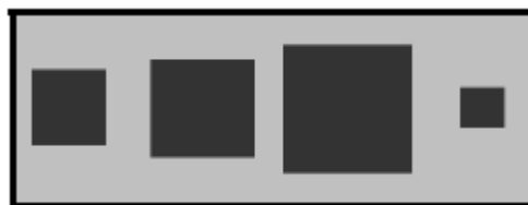
Figure 1. 19: Contrôle du déphasage par la variation de la taille de l'élément rayonnant
