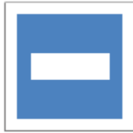
Figure 1. 20: Contrôle de la phase par le chargement d'une fente dans le patch
