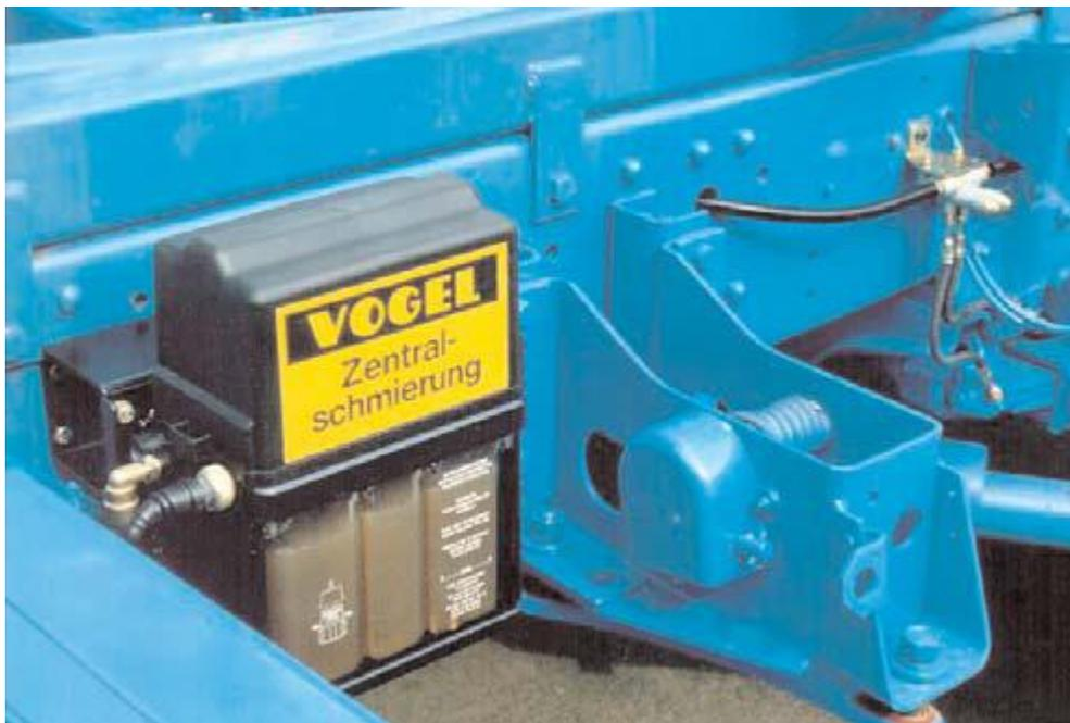
Figure (1.18) : groupe motopompe à piston monté sur le tracteur
