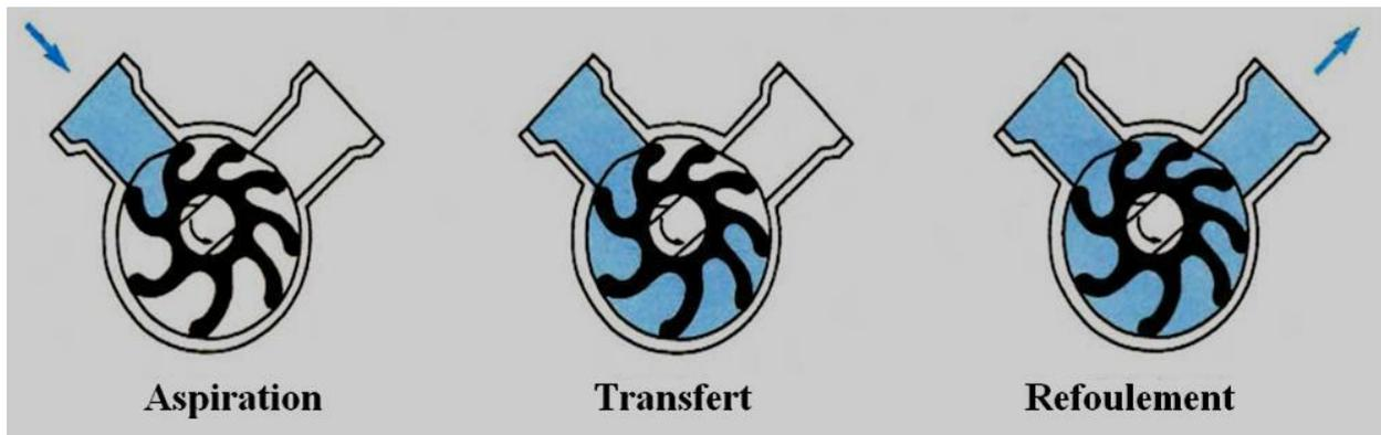
Figure (1-5) : Pompes à palettes flexibles [4]
