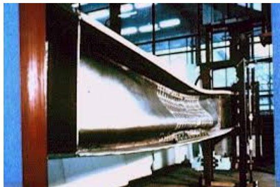
Figure 3 : Flambement d'une plaque
