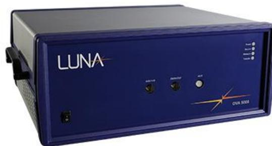
Figure (IV. 11) : Analyseur Optique Vectoriel ( OVA 500 ) de LUNA technologies
