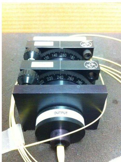
Figure (IV. 10) : Polariseur utilisé dans le dispositif expérimental
