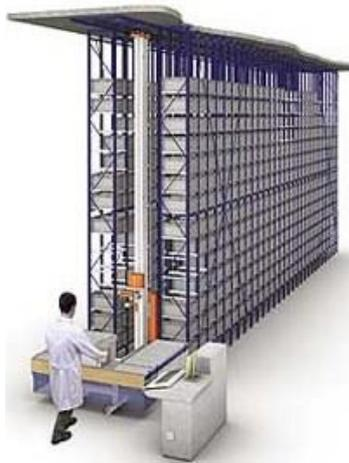
**Figure 1.8** AS/RS à charge réduite
