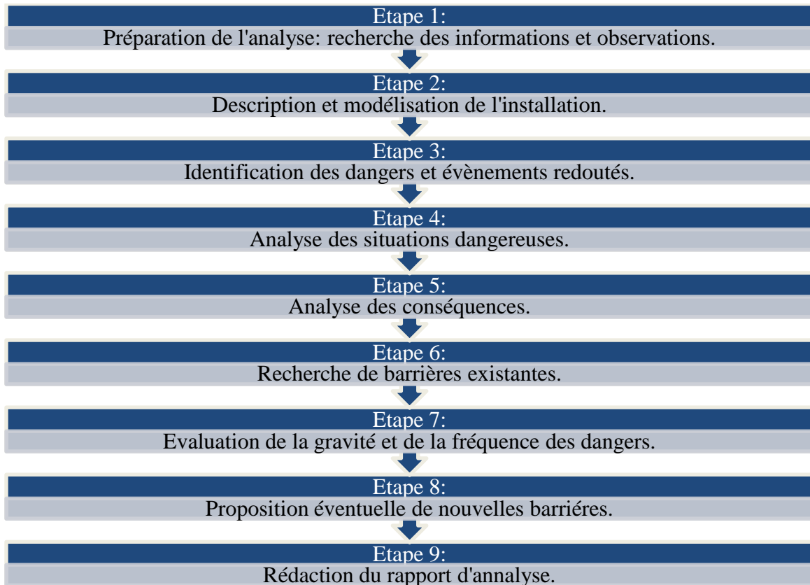
Schéma 2: Les étapes de l'analyse préliminaire du risque.
