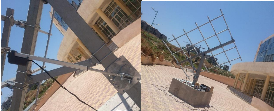
Figure 3.34 – Premier actionneur, vue de près (gauche) et vue de loin (droite)
