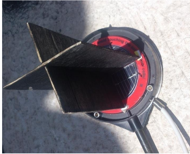
Figure 3.11 Emplacement des séparateurs
