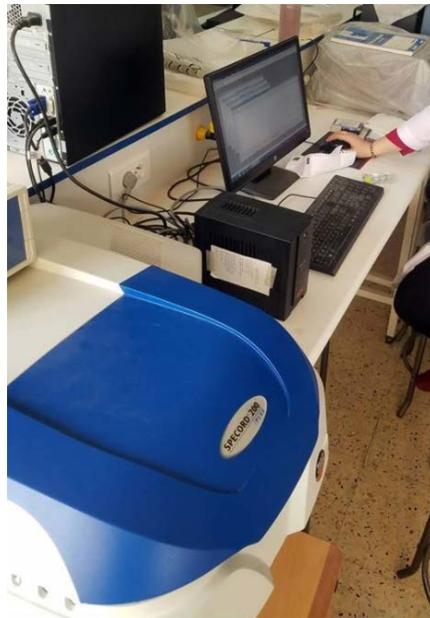
Figure 1. Spectrophotomètre UV - Visible
