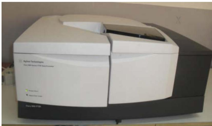
**Figure 2.** Spectrophotomètre Infrarouge à Transformée de Fourier (FTIR)
