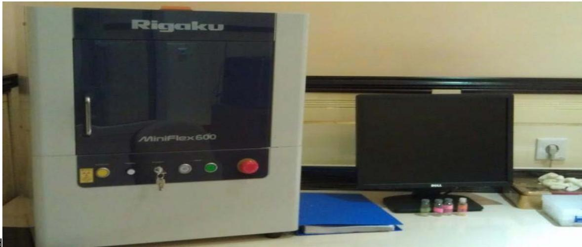
Figure 3. Diffractomètre a rayon X
