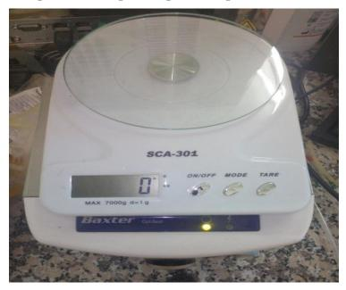
Figure 21 : Balance électronique SCA-301
