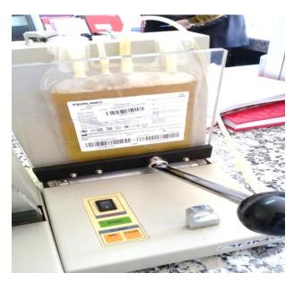
Figure 7 : Détection des fuites par un extracteur de plasma semi-automaticextractor BMS pour PFC
