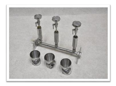
Figure 21 : Rampe de filtration
