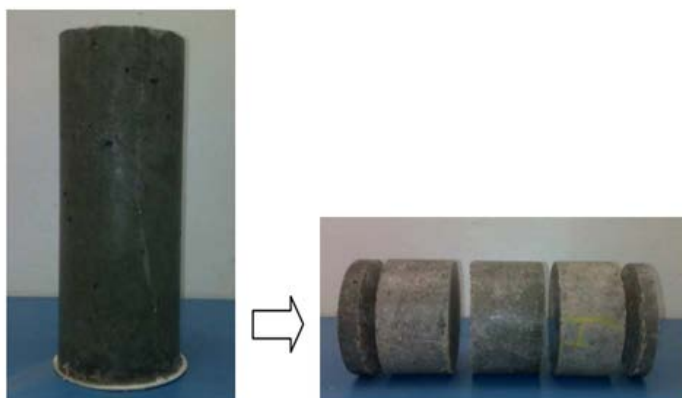
Figure A.1 : Échantillon pour l'essai de la porosité accessible à l'eau
