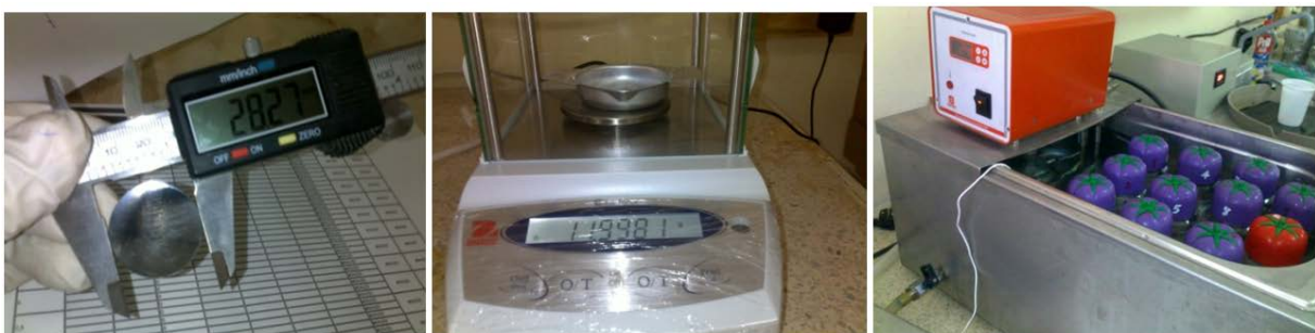
Figure III.5: Dispositif expérimental pour les essais gravimétriques
