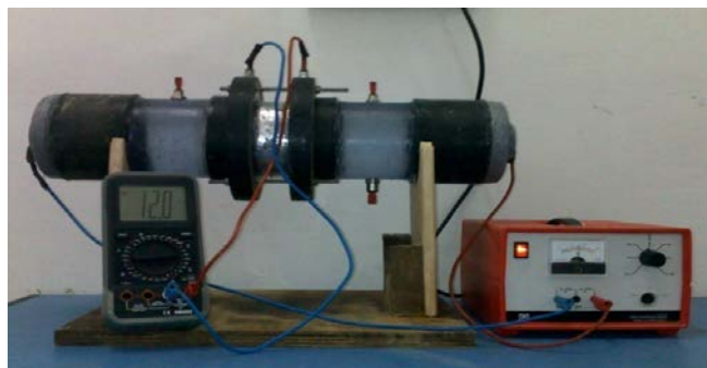
Figure III.9 : Cellule de Migration (Laboratoire de l'université de Tlemcen)
