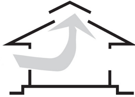
Figure 4.5 : Ventilation naturelle par tirage thermique [11].
