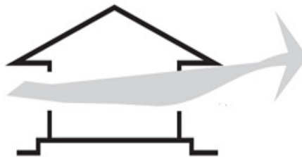
Figure 4.3 : Ventilation naturelle par effet du vent [11].
