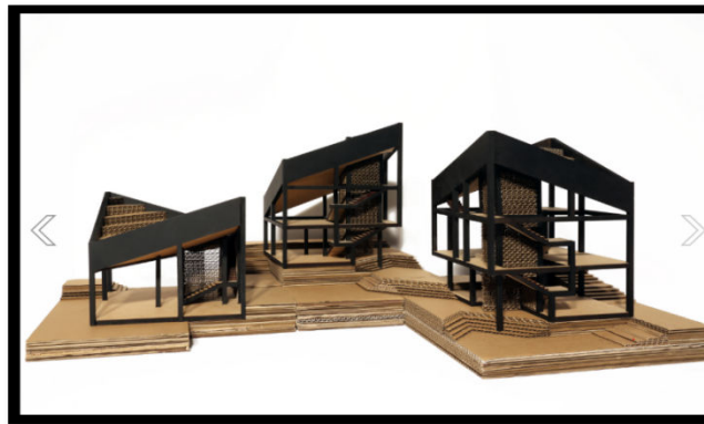
Figure 2-29 : le système constructif.
