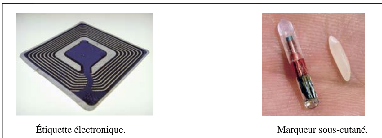
Figure I.4. Exemples de puces RFID [6]
