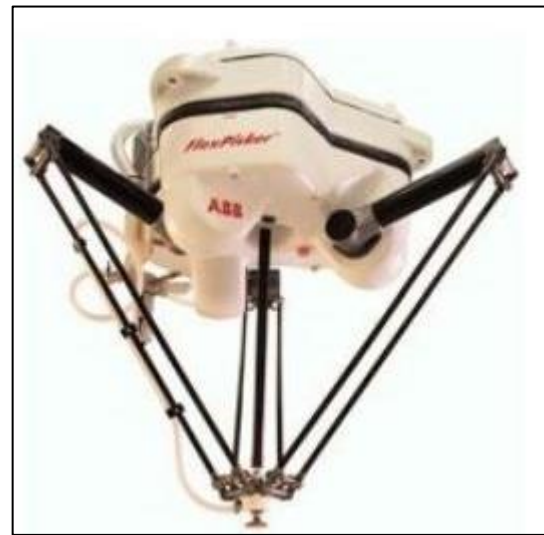
Figure II.4. Bras manipulateur série [17] Figure II.5. Bras manipulateur parallèle [18]
