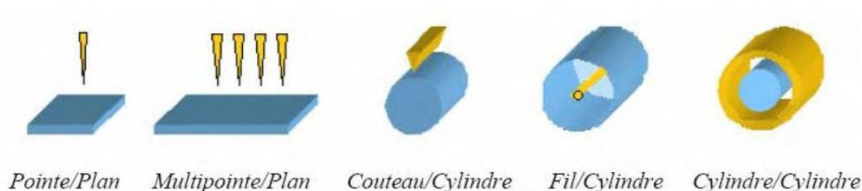
Figure I-12 : Différentes Configurations de Décharge Couronne [33].
