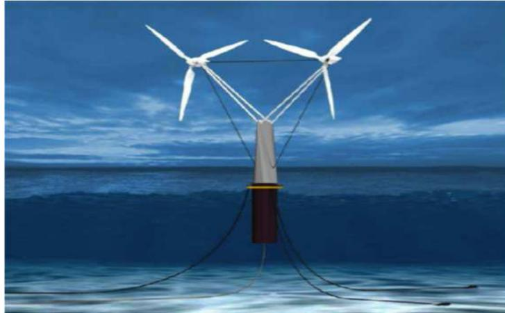
FIGURE 4.1 : Structure SEREO [30] composée de deux turbines.
