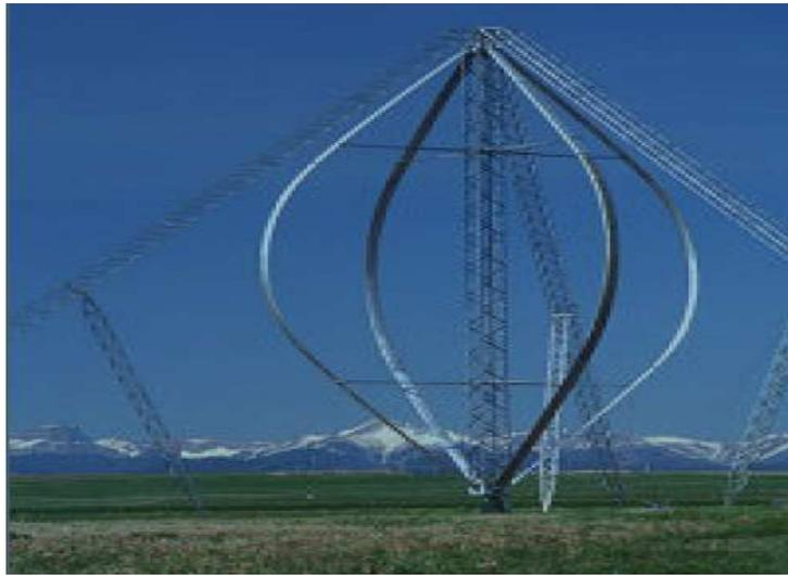
FIGURE 1.2 : Éolienne à axe vertical [14].
