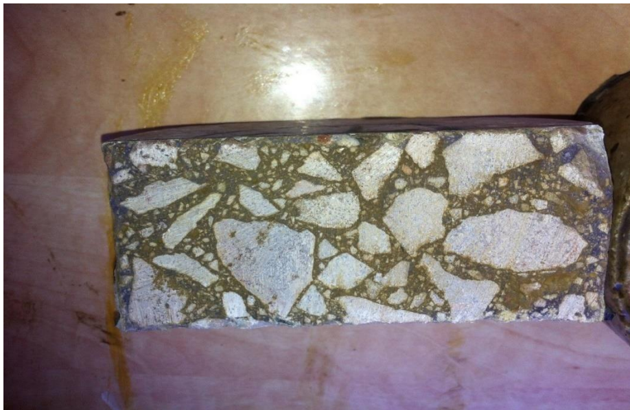
Figure IV-39: Front de pénétration des chlorures pour des courtes durées
