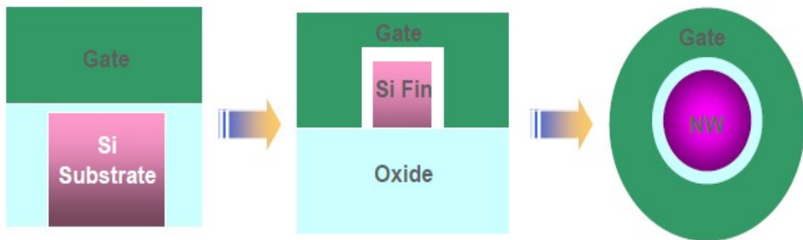
Figure 2-14: Développement de la structure du dispositif classique seule grille plane vers structure totalement GAA. [49]
