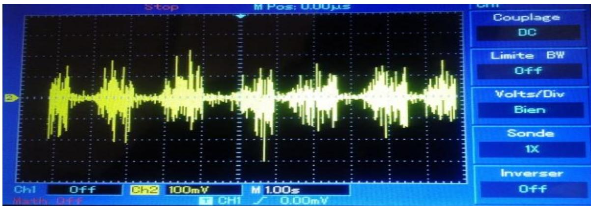
Figure III.9 : Le signal d'EMG à la sortie de filtre passe haut sellen &Key de 2ieme ordre
