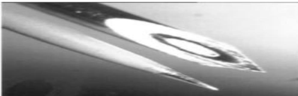
Figure I.18: L'électrode aiguille [27]
