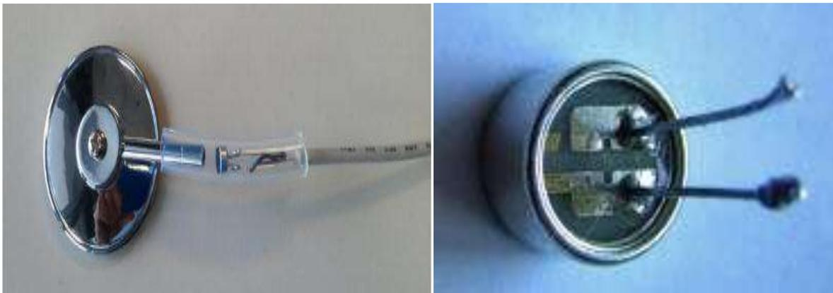
Figure III.8 : Microphone à électret.
