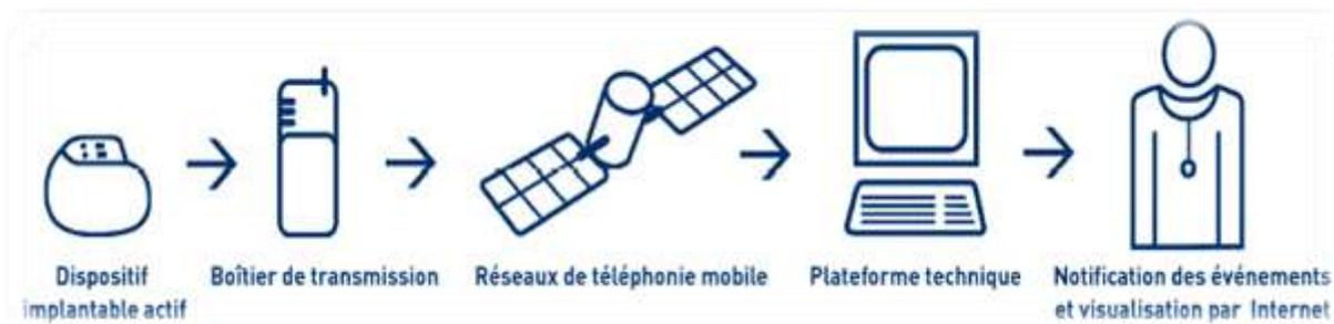
**Figure II.7** : Système de la télé-cardiologie.
