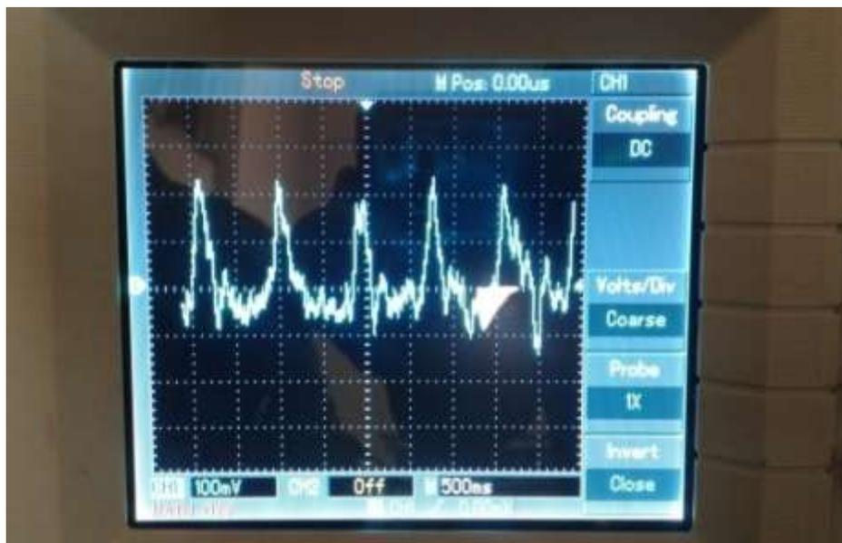
Figure III.23: Tracé du signal PPG visualisé sur oscilloscope.
