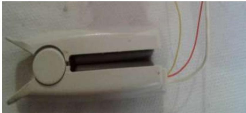
**Figure III.16:**Capteur du signal PPG.
