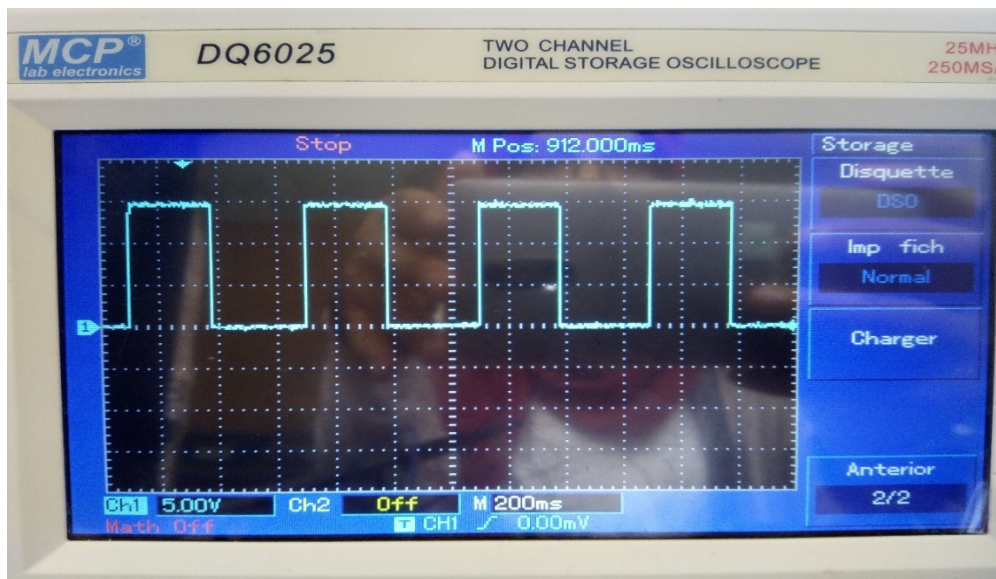
Figure 3.19 : Point M : la sortie de l'oscillateur
