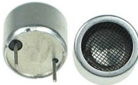
Figure 1.5: Capteur à ultrason standard pour une fréquence supérieure à 40 KHz
