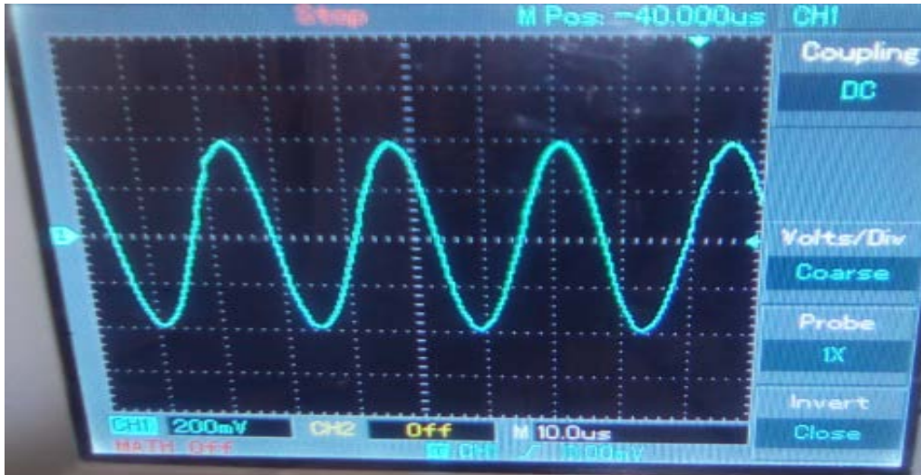
Figure 3.10:Point E : sortie de récepteur
