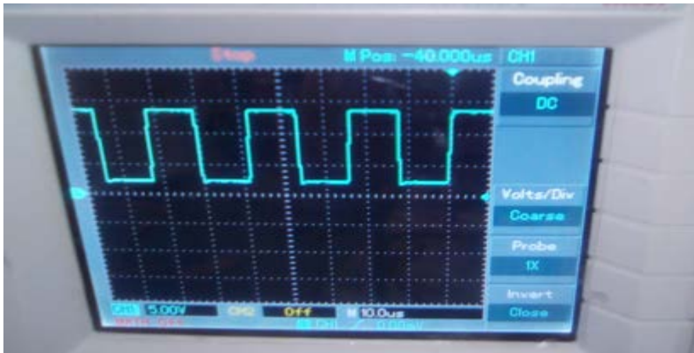
Figure 3.13:Point H : sortie du collecteur de transistor T1
