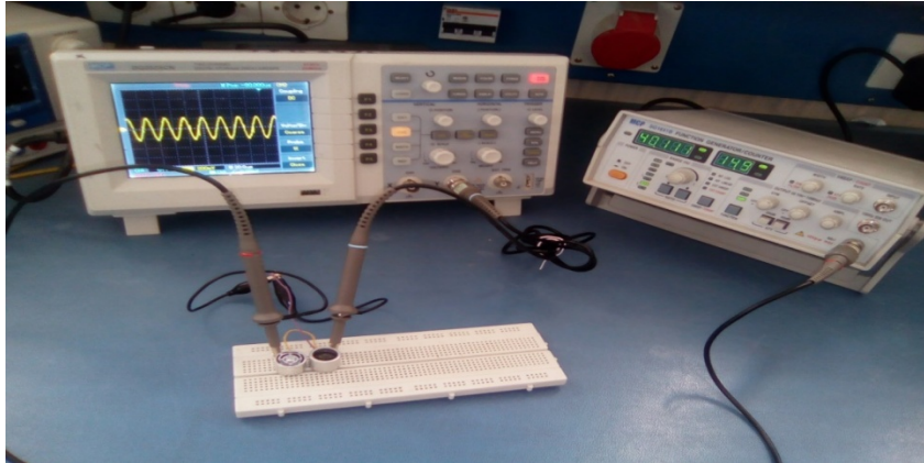
Figure 3.4: Photo de test de transducteurs sur la plaque d'essai
