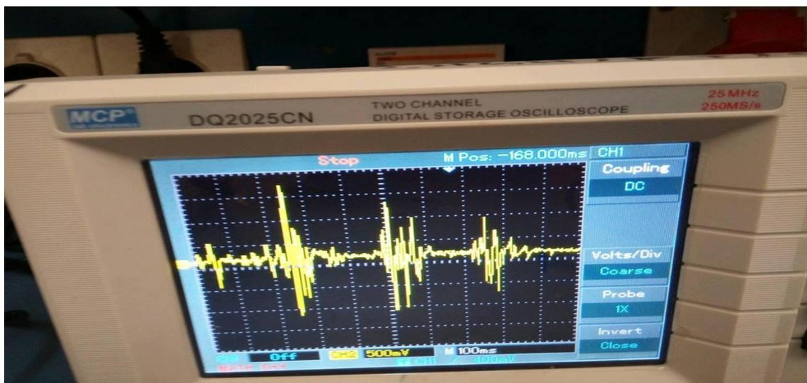
Figure III-6 Amplification de signal EMG par l'amplificateur d'instrumentation INA114
