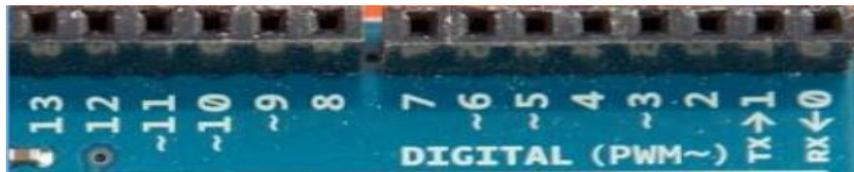
Figure II-19 Les entrées / sorties numériques dans la carte Arduino[26]
