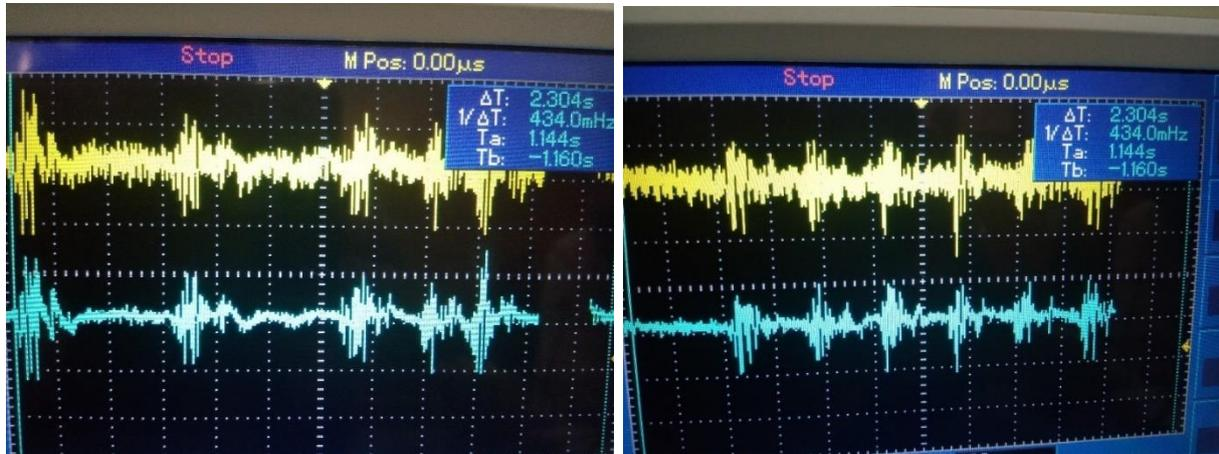
Figure III-13 Filtrage de signal (en jaune le signal EMG non filtré et en bleu signal filtré)
