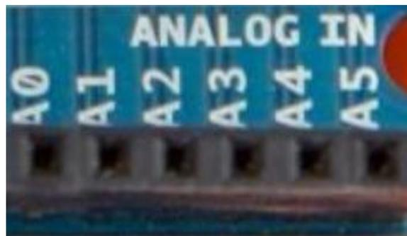
Figure II-20 les entrées /sorties analogiques [26]
