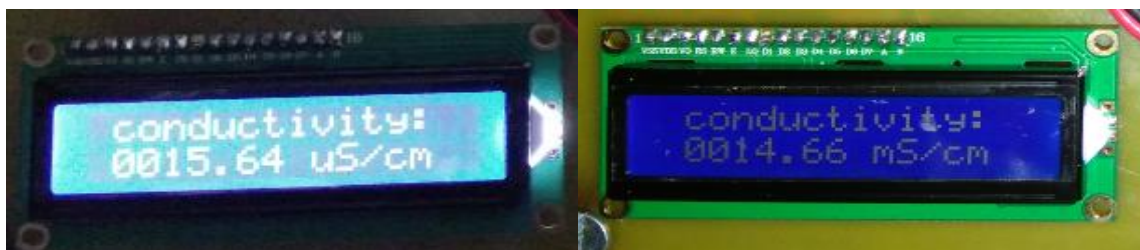
Figure IV.19 : conductivité à la sortie de l'osmoseur et celle du dialysat respectivement.
