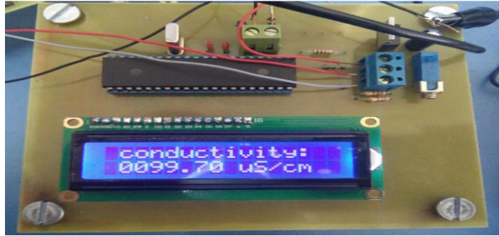
Figure IV.15: La réalisation pratique du circuit d'affichage et résultat obtenu.
