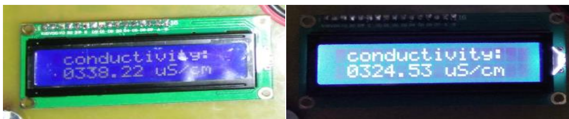
Figure IV.18 : Conductivités : à la sortie de l'adoucisseur et du filtre à charbon actif respectivement.
