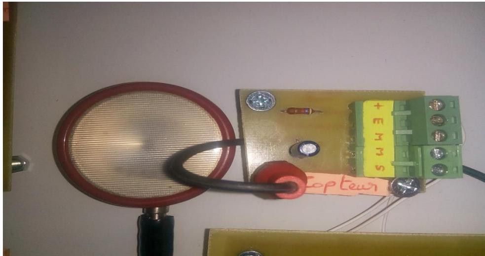
Figure3.29 : réalisation du circuit de microphone
