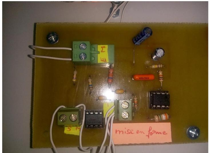
Figure3.38 : réalisation du circuit de mise en forme du signal PCG
