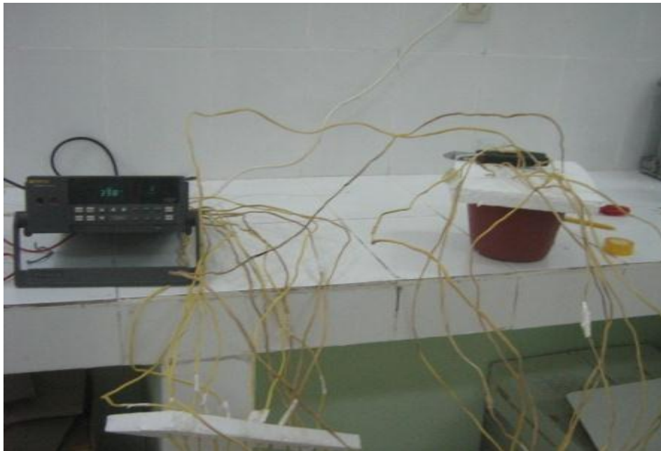
Figure N°34. Étalonnage des thermocouples à 0°C
