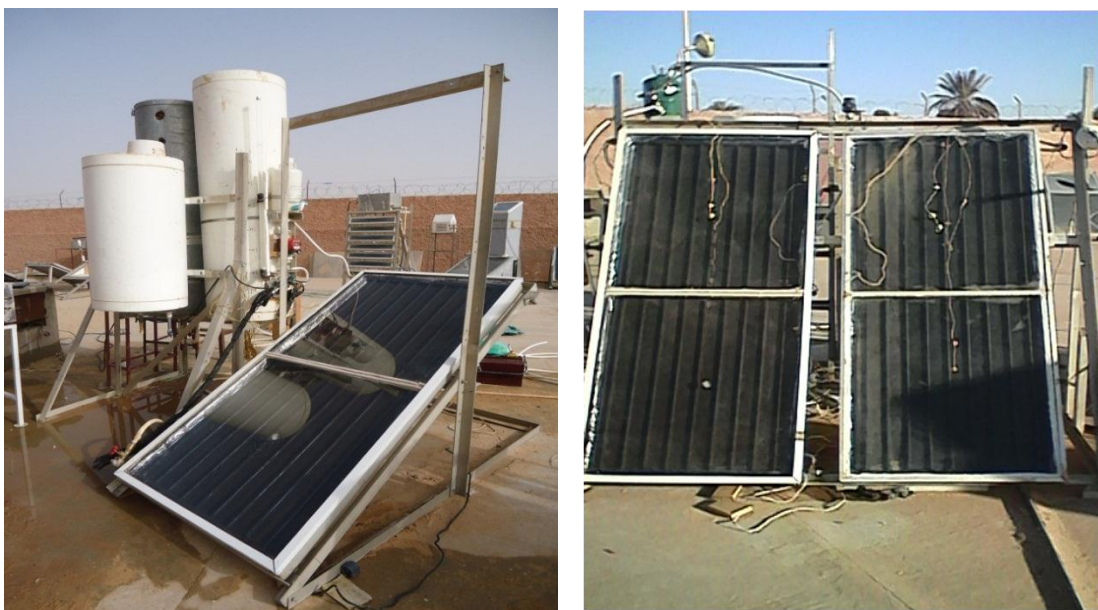
Figure N°3 Photo du chauffe-eau avec deux capteurs solaires plans réalisés à l'URER/MS
