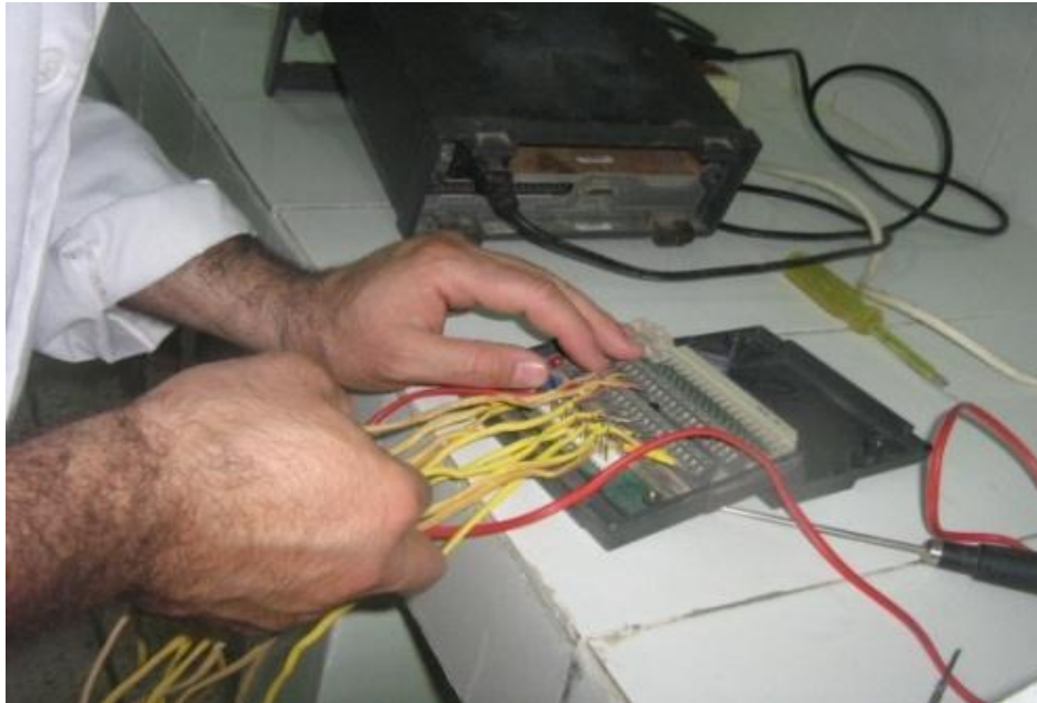
Figure N°33. Montage des thermocouples
