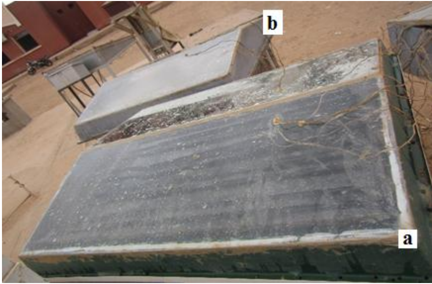
Figure N°32. Distillateurs étudiés : a ) à ailettes , b) sans ailettes
