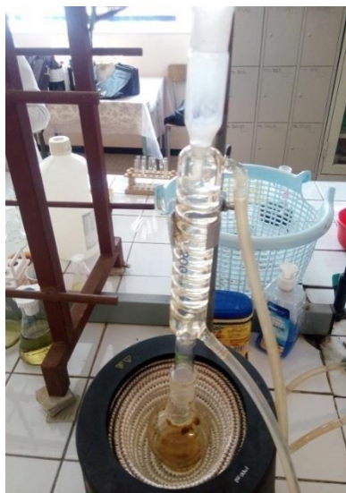
Figure 6 : Montage du reflux.
