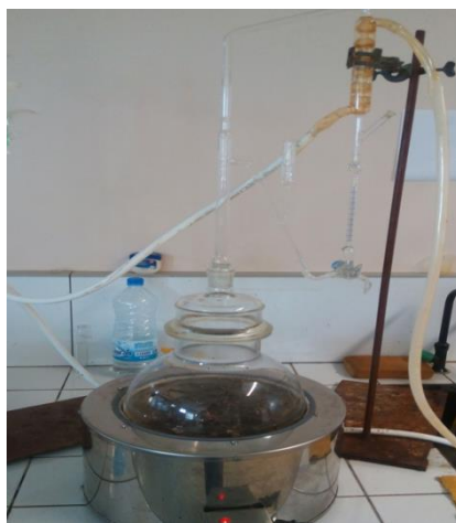
Figure 7 : Montage de l'hydrodistillation
