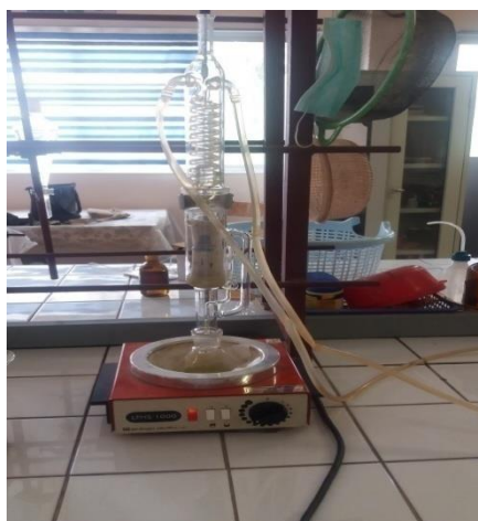
Figure 5 : Montage de soxhlet.
