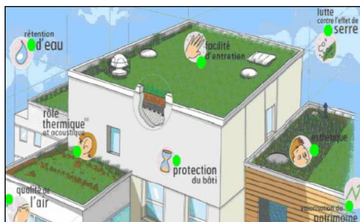
Figure 6-11 : Les avantages de la végétalisation des toitures , source : pdf Toiture-terrace végétalisée extensive à Andrésy (p81).
