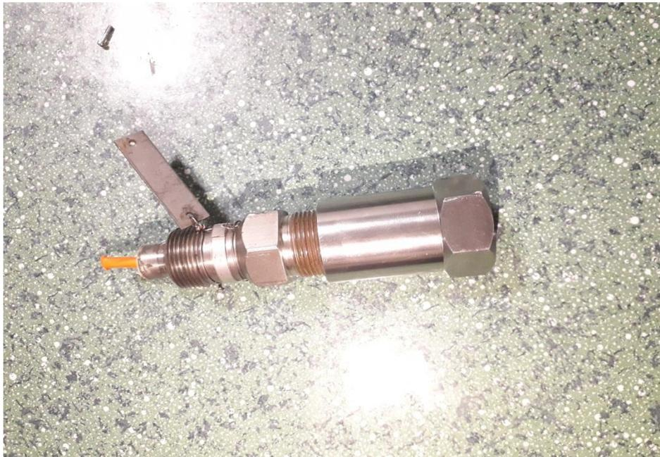
Figure I..11 : Détecteur de flamme (Détecteur ultraviolet)
