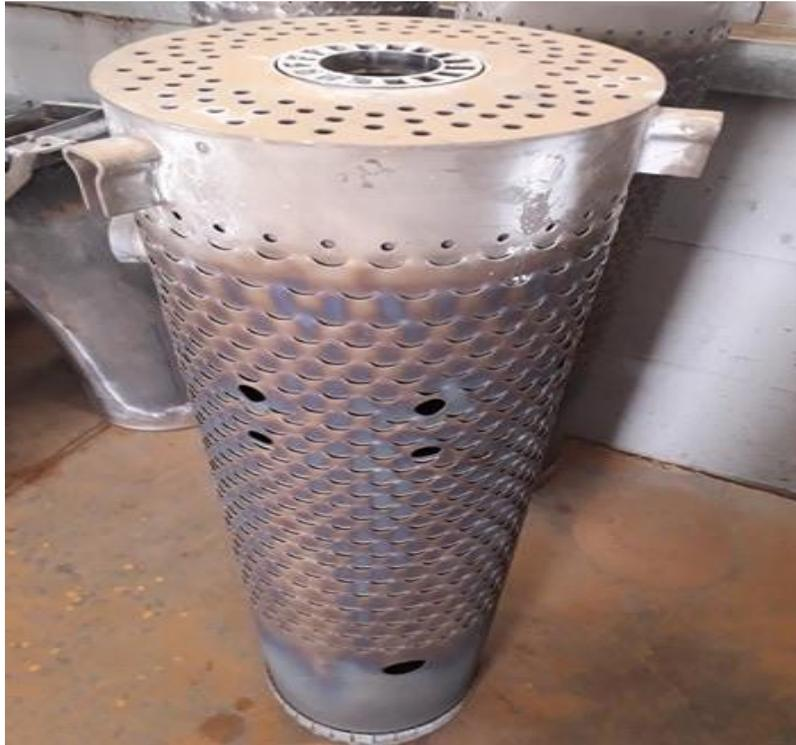
Figure I.8 :La chambre de combustion
