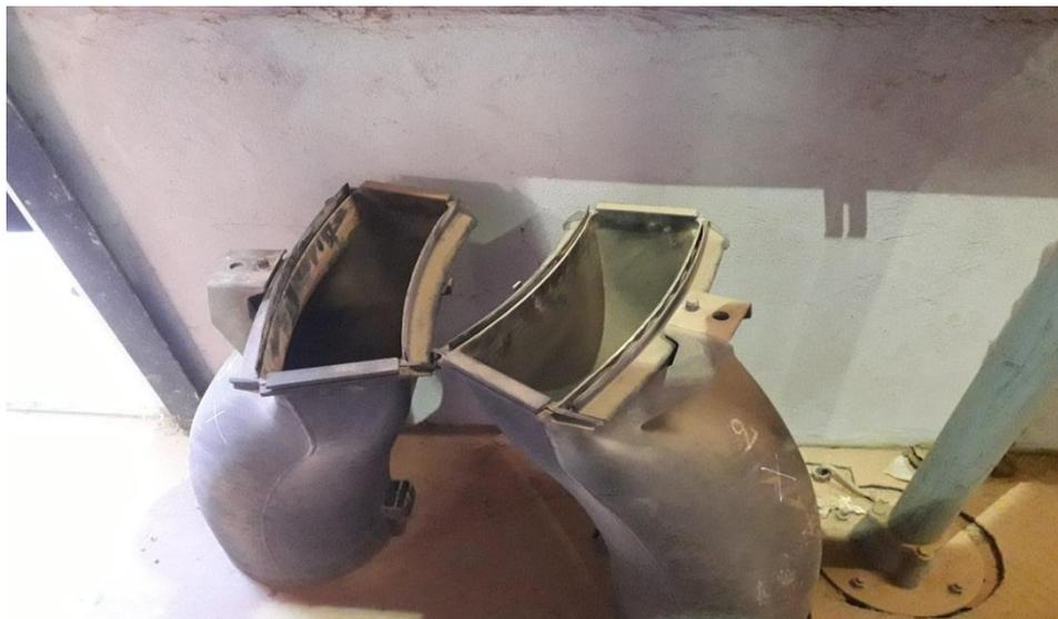
Figure I.13 : Les pièces de transition
