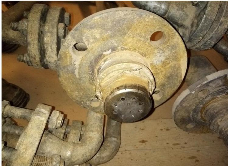
Figure I.12 :Les injecteurs de carburant
