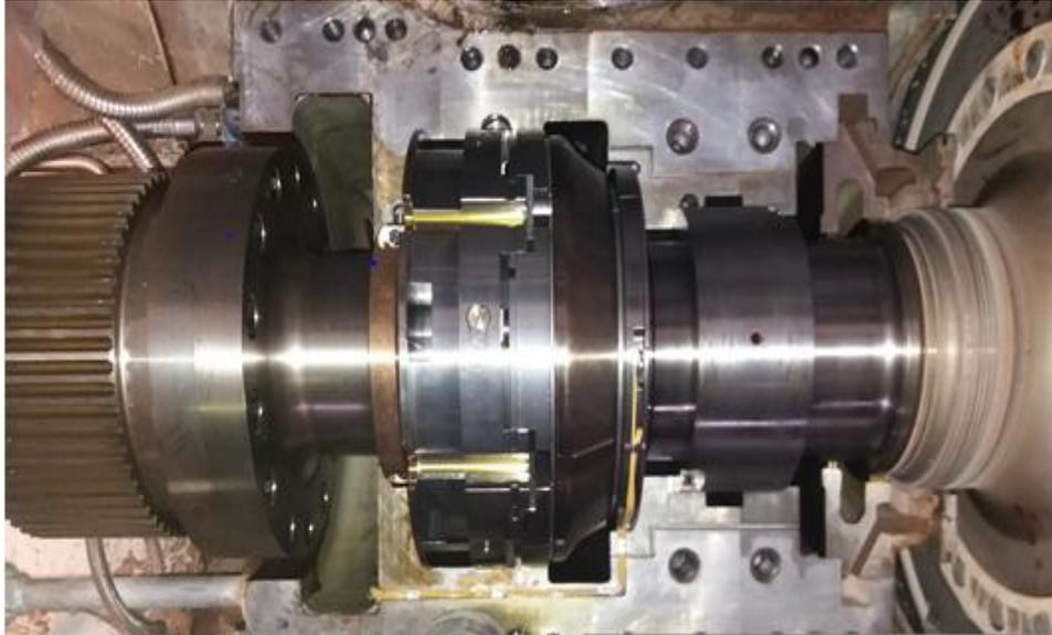
Figure I.17 : le palier no 01 du rotor
