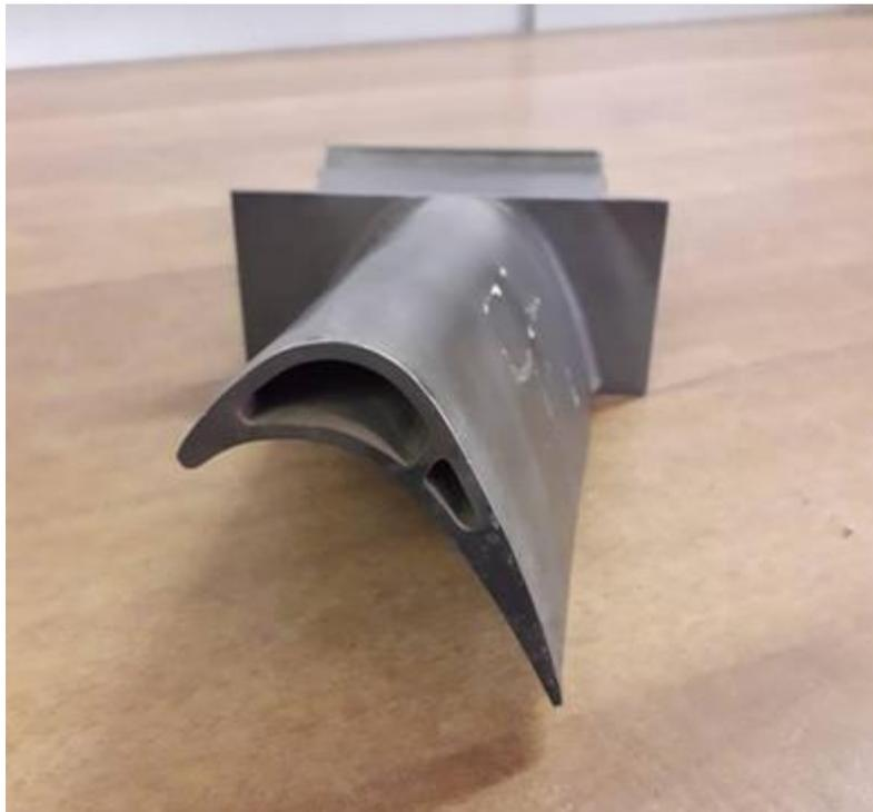
Figure II.1 : Aube HP de la turbine MS5002B
