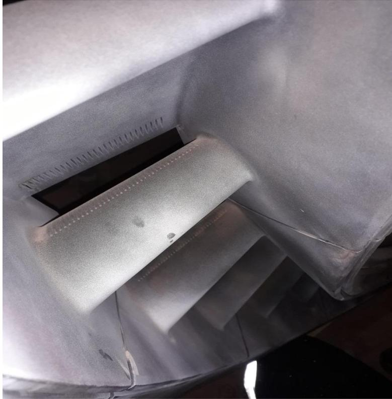
Figure I.5 : Aubes 1er étage (Directrice 1er étage) les EGV
