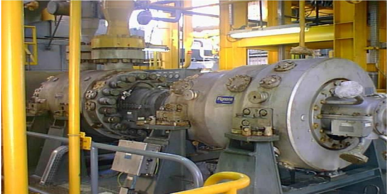
Figure I.1: Exemple d'une turbine entraînant un compresseur [2]
