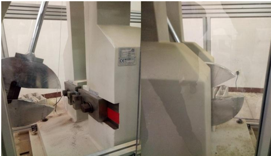
Figure III.27 - Position de pendule avant et après la rupture de la pièce
