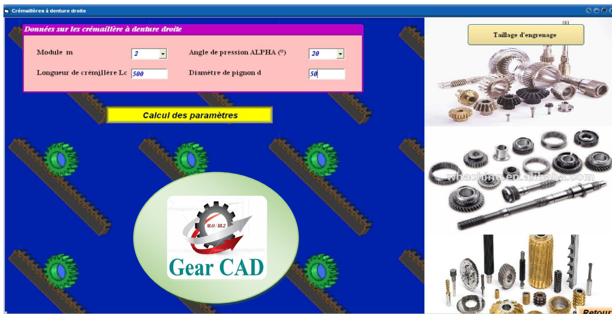
Figure 2.23 : Données des crémaillères à denture droite.
