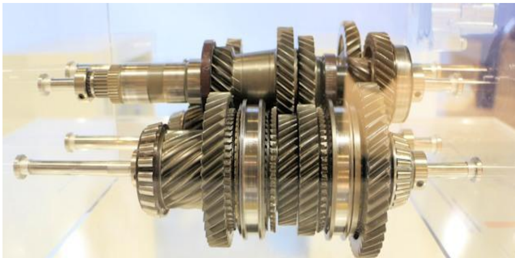
Figure 1.17 : Boite à vitesse automobile [1].
