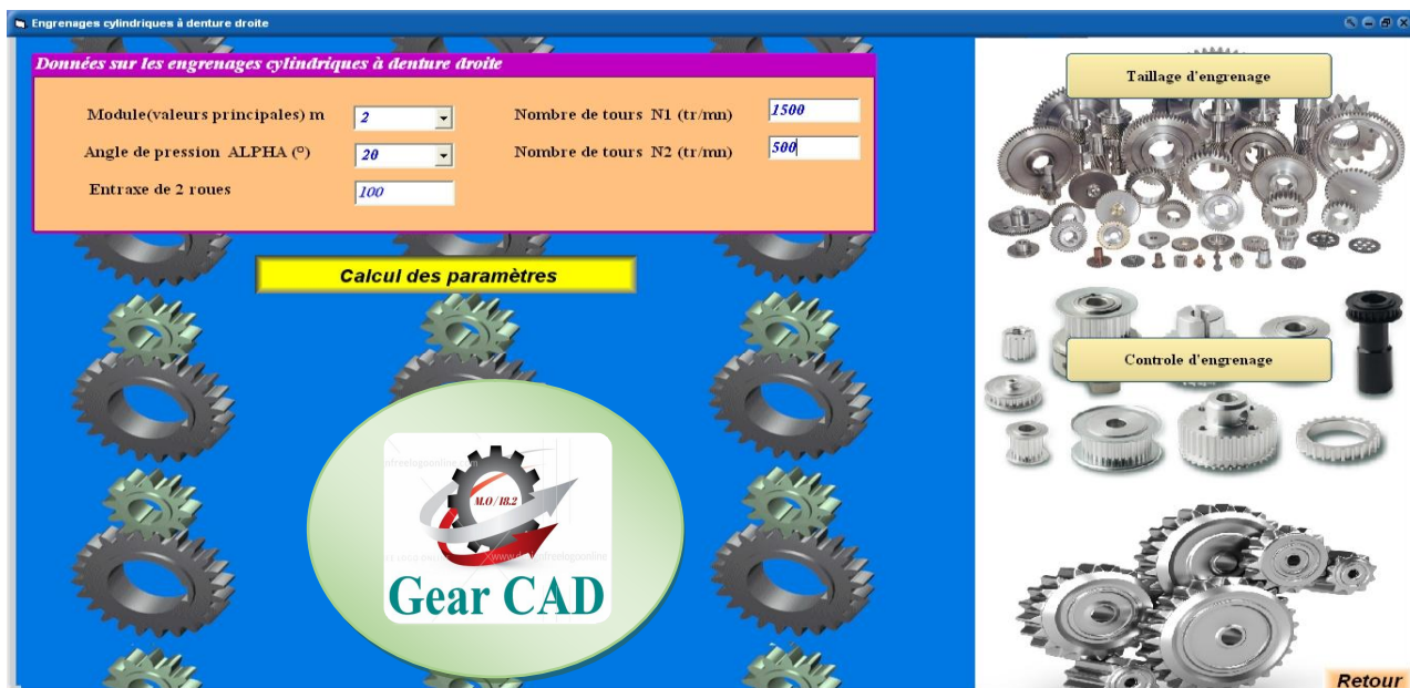
Figure 2.32 : Représentation des données des engrenages droites.
