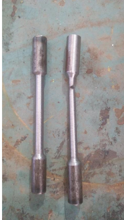
Figure (3.19) : Eprouvette avant et après l'essai
