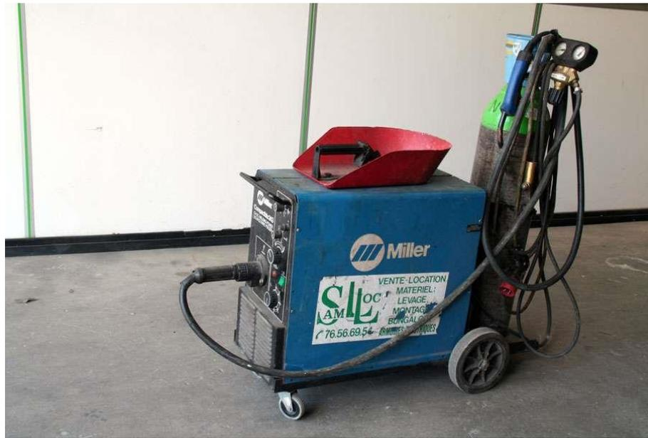
**Figure 2.8 : Installation de soudage MIG/MAG.**
