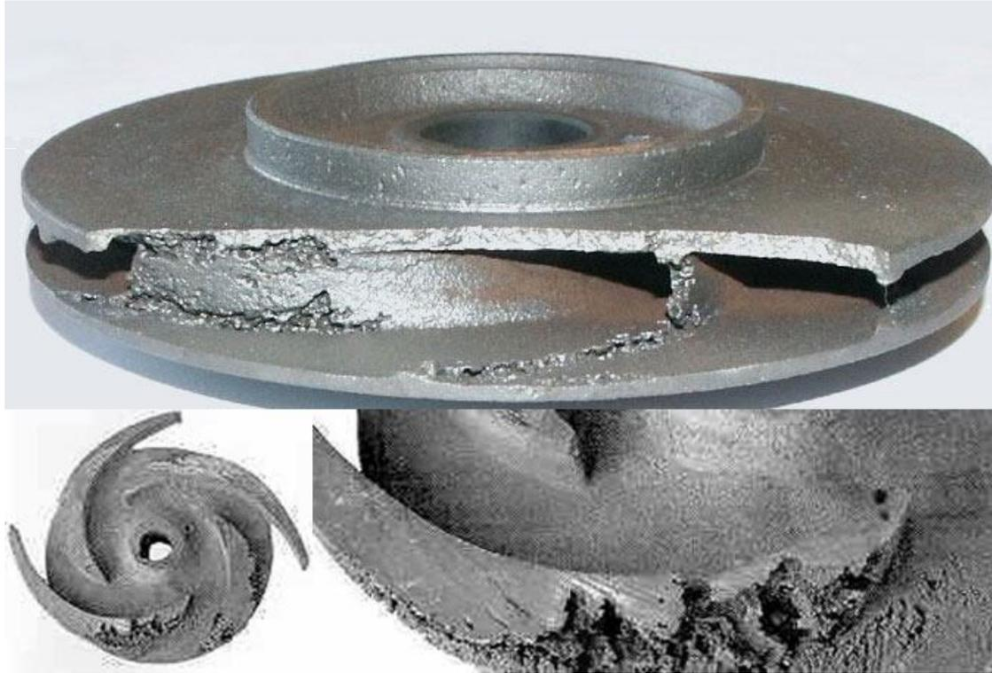
Figure III.13: *Photo illustrant la cavitation sur un impulseur.*
