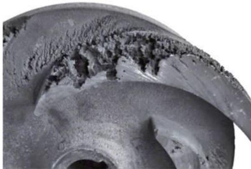
Figure III.16: *Usure par cavitation d'un impulseur de pompe centrifuge.*
