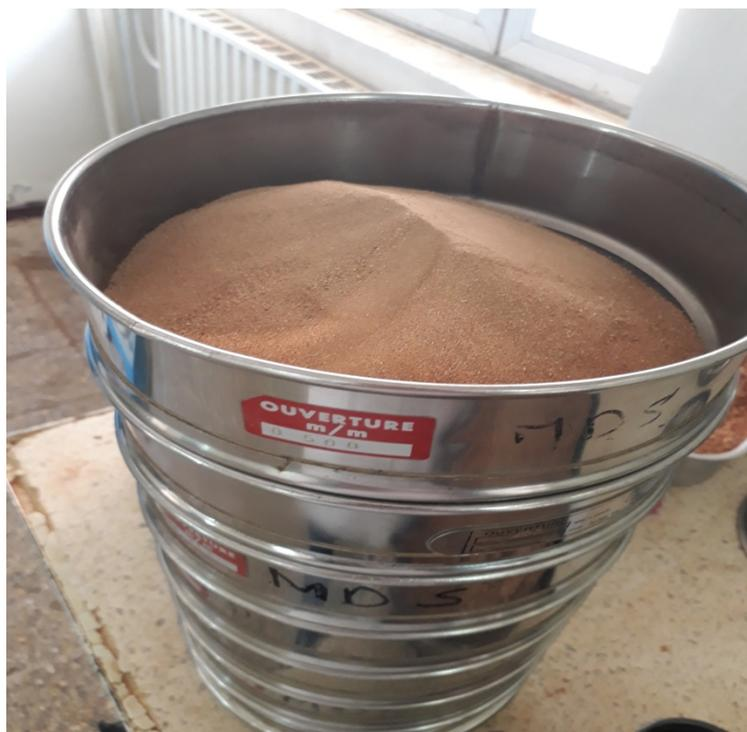
**Figure II.8 :** les tamis utilisé à l'analyse granulométrique
