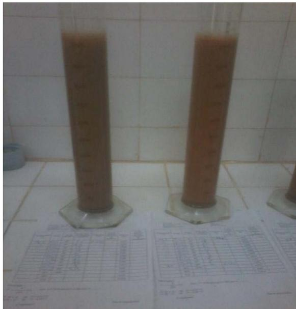
**Figure II.9. :** mesuré de la densité apparent
