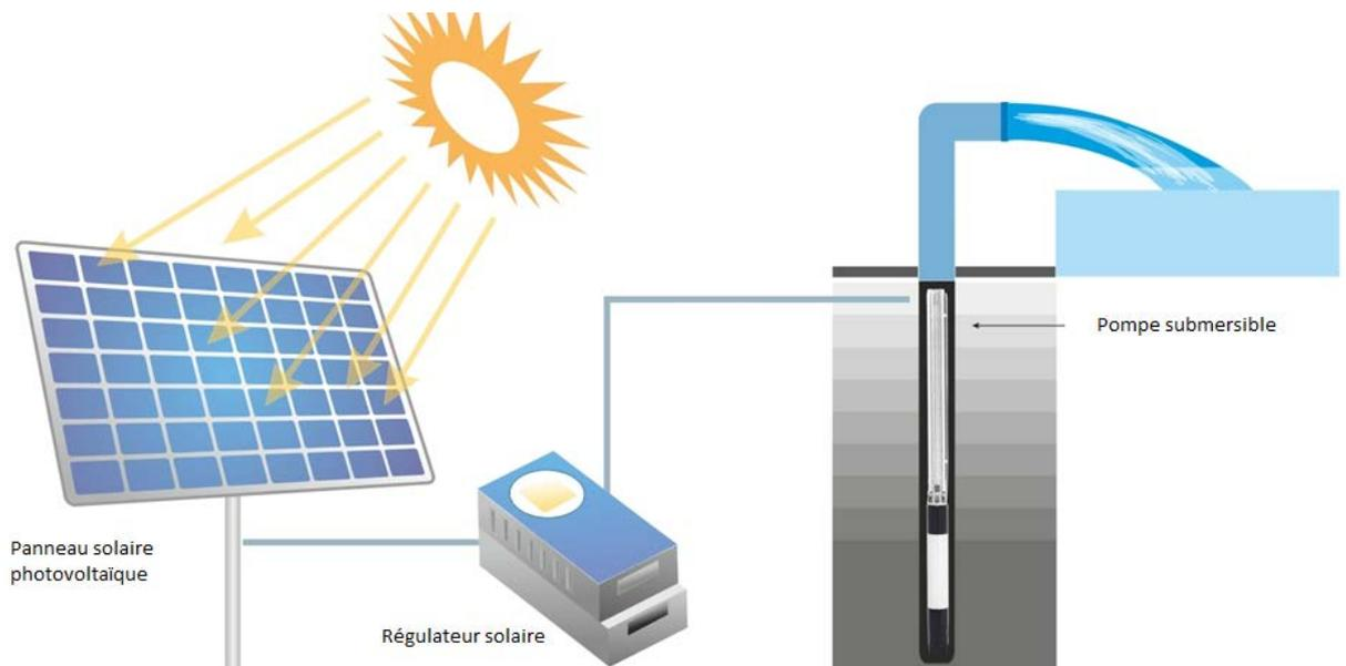
**Figure III.3.** Pompage au fil du soleil (stockage de l'eau) [28]
