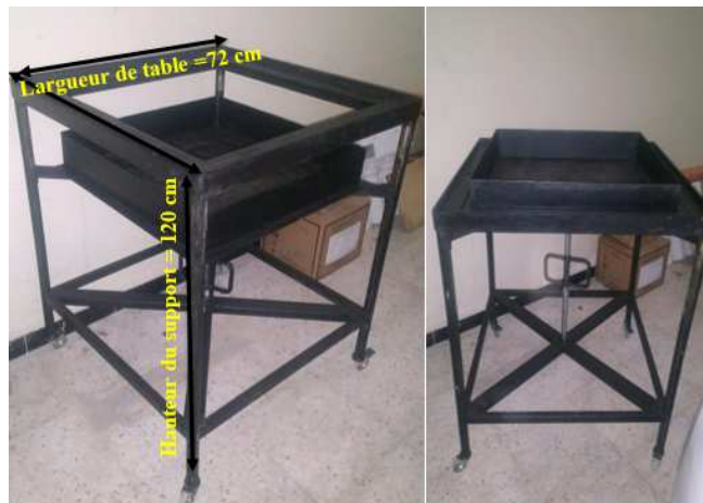
Figure 5.3 : Table élévatrice et système de coulissement
