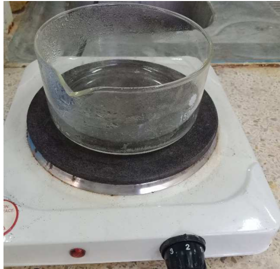
Figure 6.3 Chauffage des eaux saumâtre
