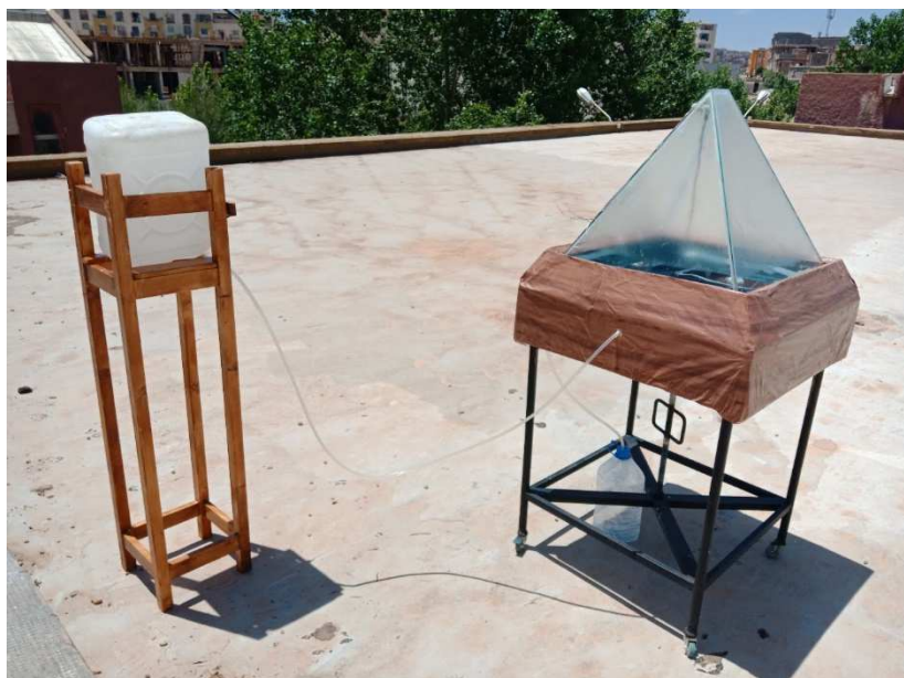
Figure 5.7 : Vu du prototype et du système d'alimentation du bac
