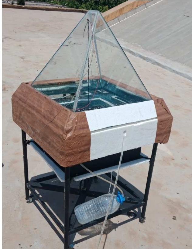
Figure 5.8 : Vu du prototype et du système d'isolation
