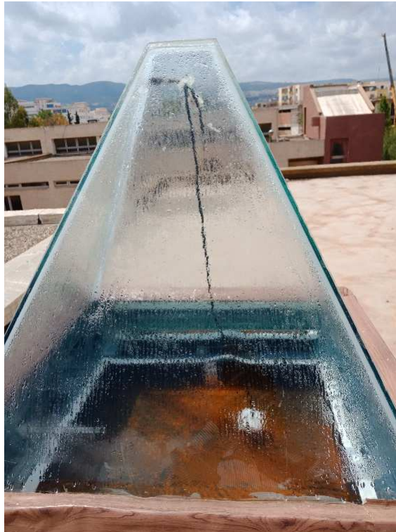
Figure 5.5 : Condensation de la vapeur en tête du prisme et sur les parois
