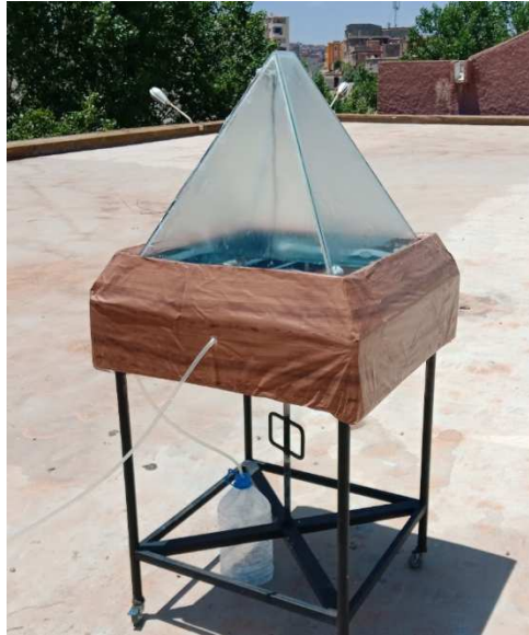
Figure 5.6 : Vu du prototype et du système d'évacuation du perméat
