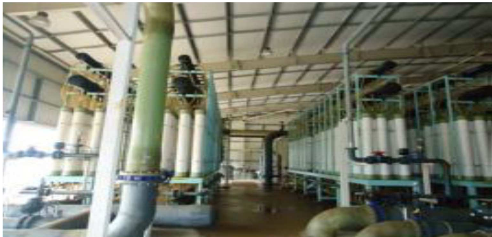
Photo. 5 : Représentation d'un train de cartouches d'Ultrafiltration. (Source : HACHEMAOUI, 2014).
