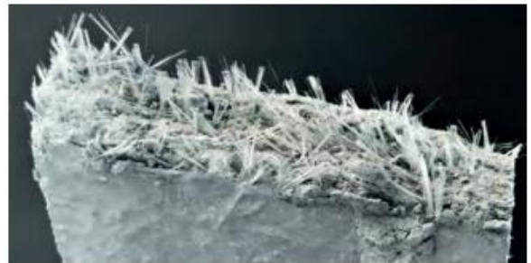
Figure 207 : Renforcement de fibre dans le composite ciment-verre
