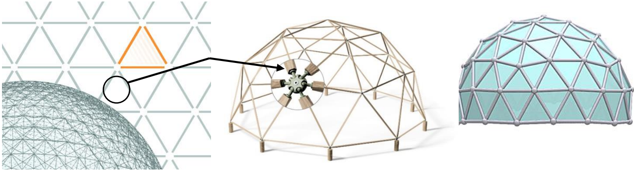
Figure 59 : la structure de dôme géodésique
