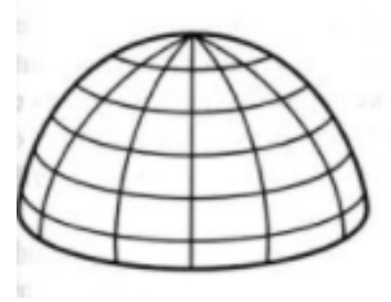
Figure 61 : la forme de dôme nervuré
