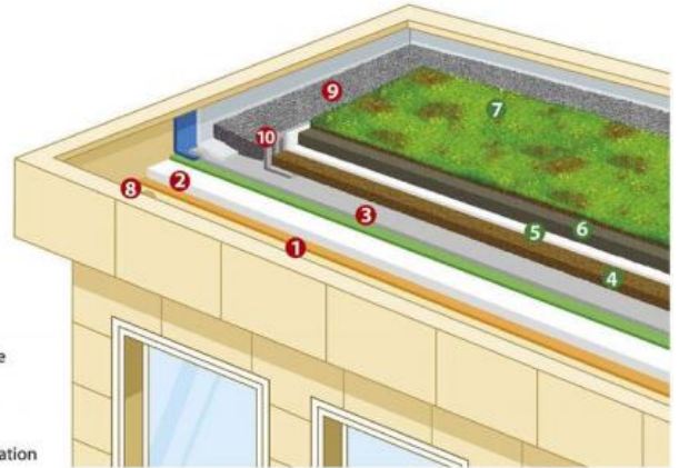
Figure 53: Les éléments d'une toiture végétalisée
