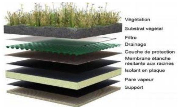
Figure 52: la toiture végétalisée
