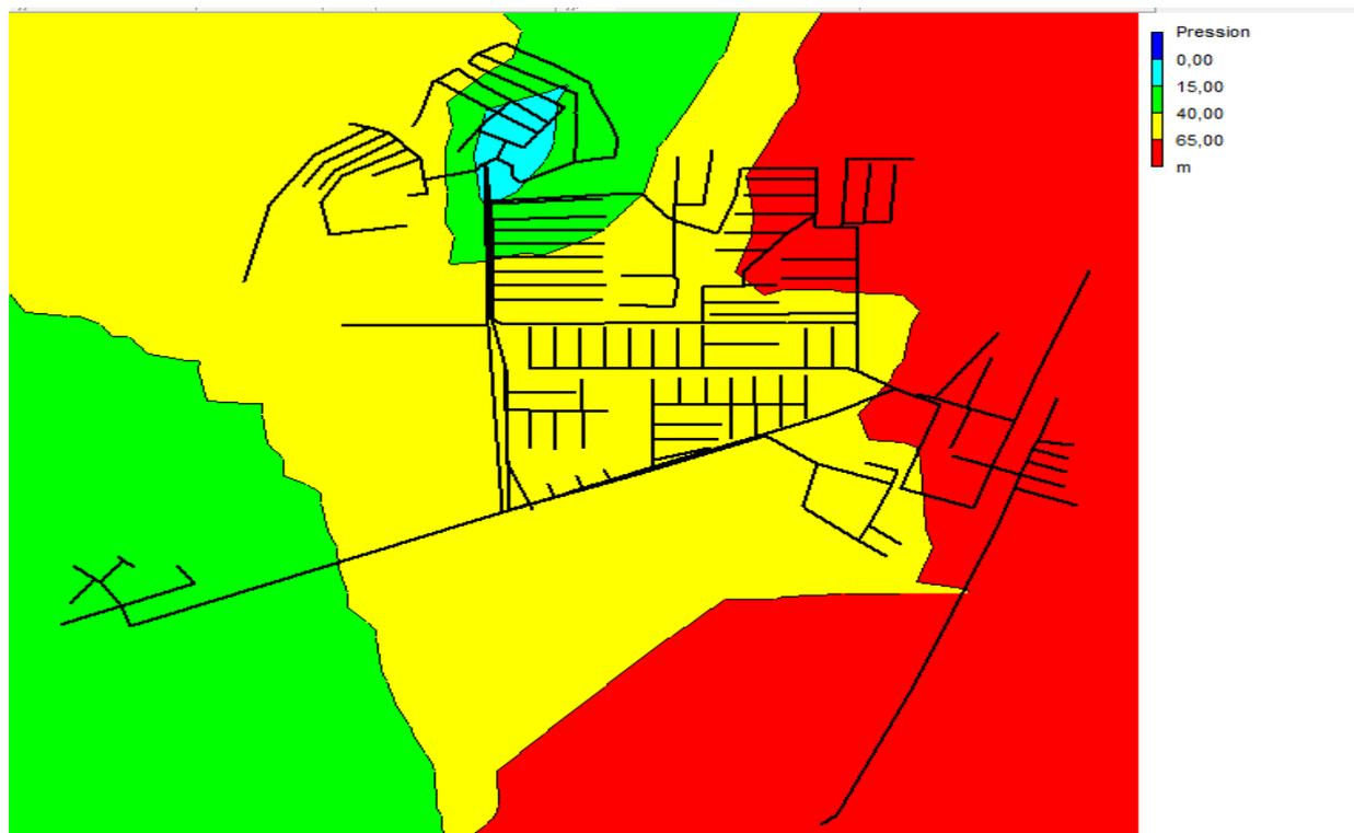
Figure III-7 Variation de la pression pendant les heures creuses
