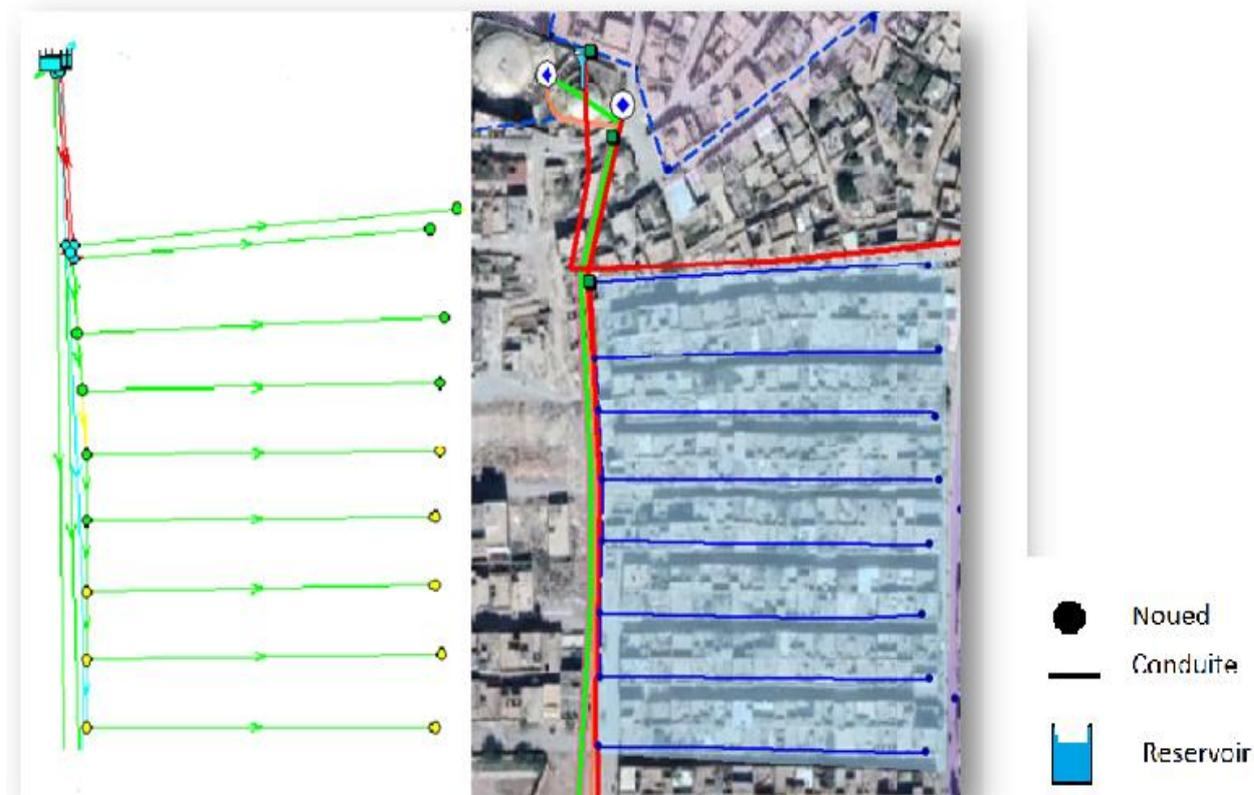
Figure III-12 : le résultat de la simulation sur Epanet pour secteur 3
