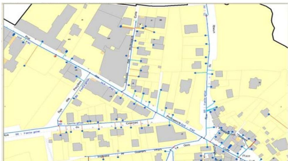
Figure I- 4 : Extrait de plan de secteur du réseau d'alimentation en eau potable.
