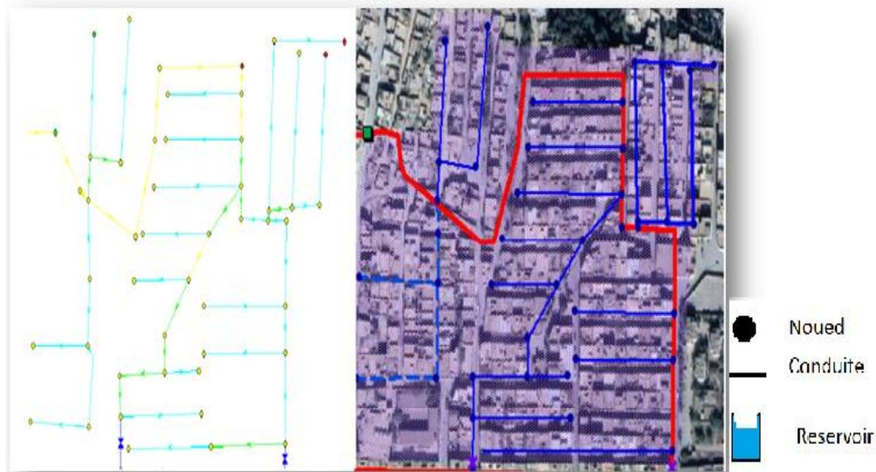
Figure III-13 : le résultat de la simulation sur Epanet pour secteur 4
