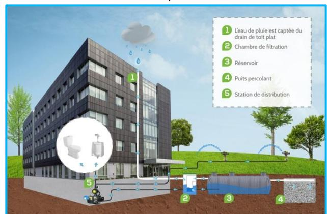
**Figure 102.** Système de récupération avec avec toit plat.
