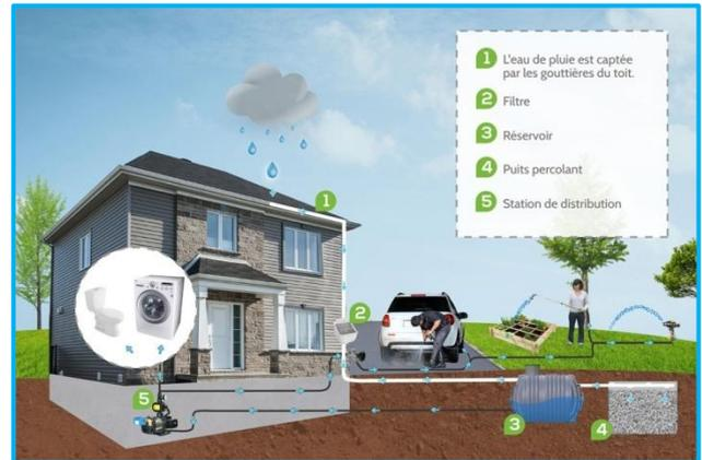
**Figure 101.** Système de récupération avec gouttières.
