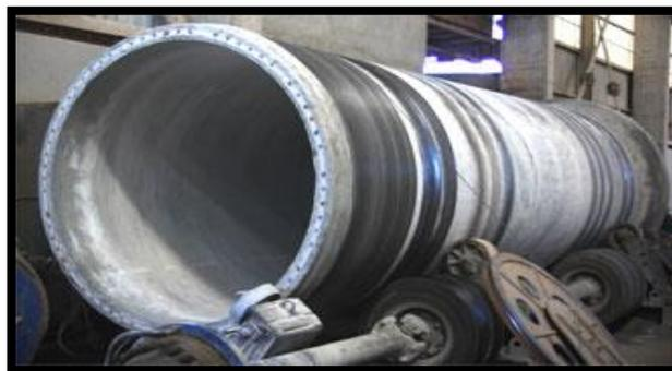
**Figure I.8 :** Tuyaux en béton armé. [5]
