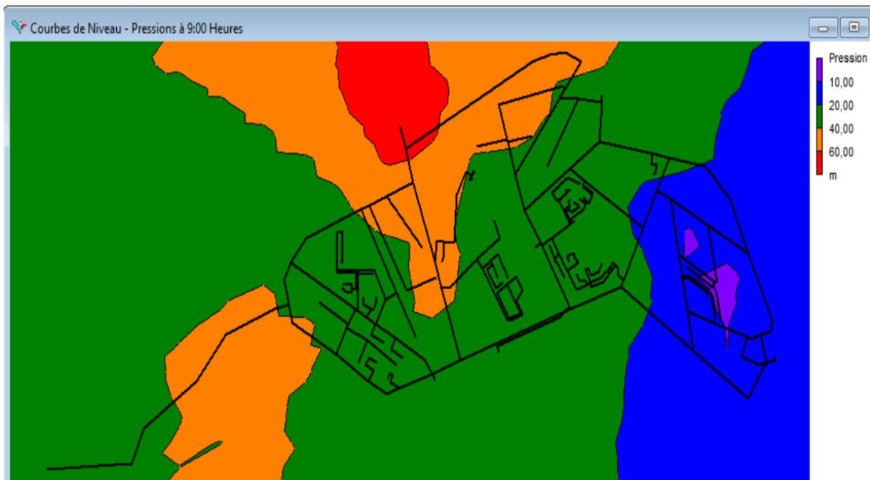
Figure.IV.20. Enveloppes de pression à 9h pour le modèle 2 de consigne 4 bar
