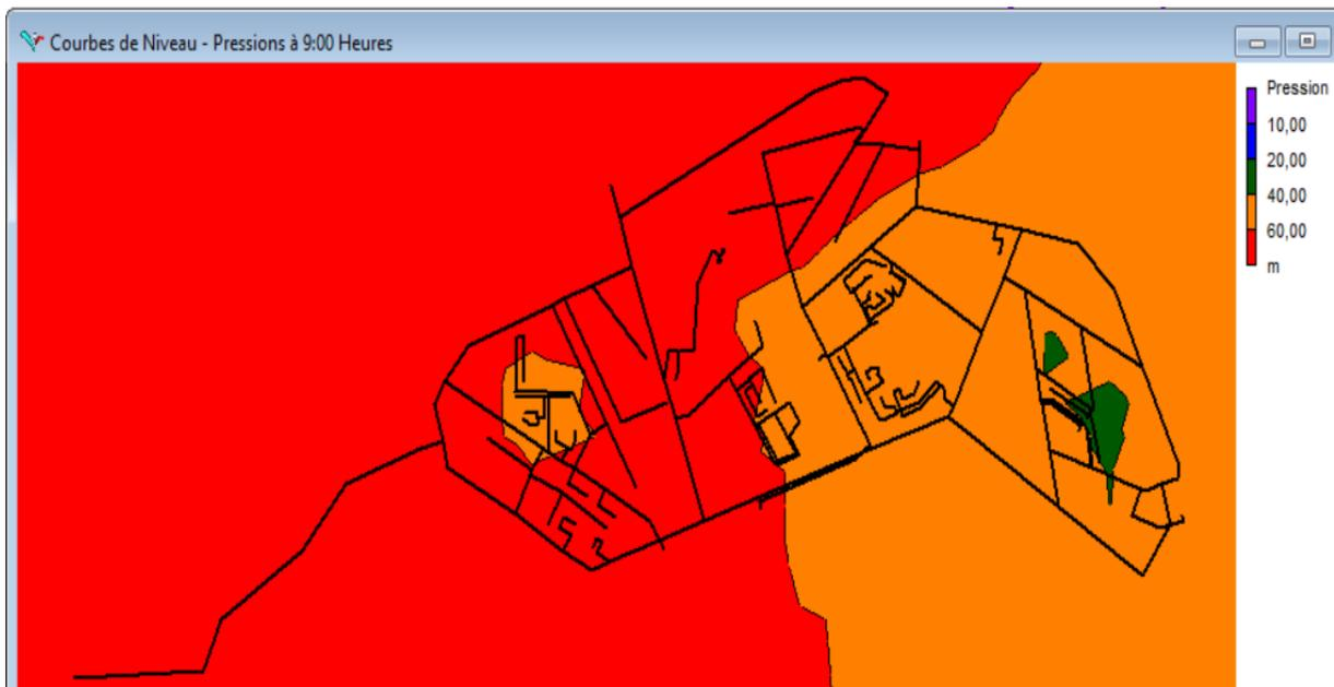
Figure.IV.16. Enveloppes de pression à 9h pour le modèle 2 de consigne 7 bar
