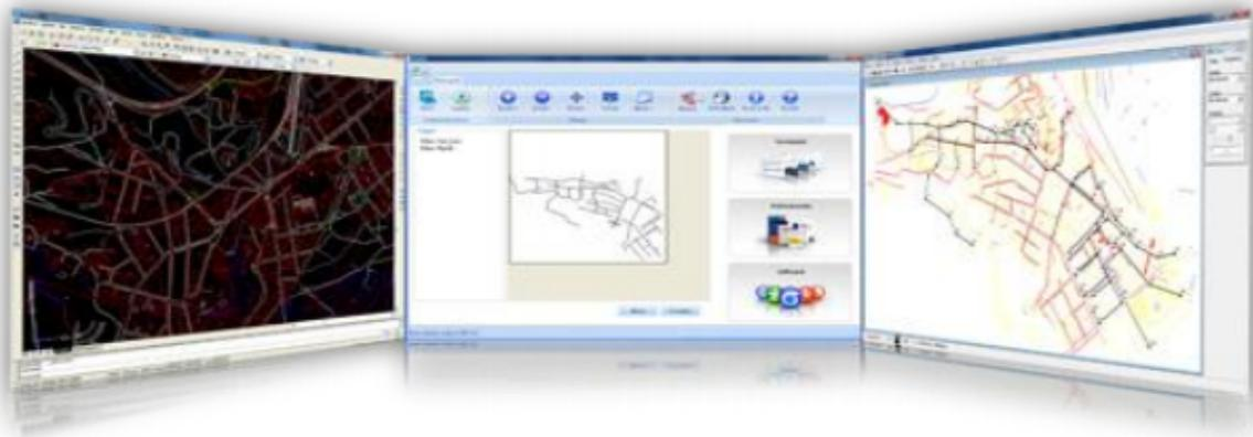
Figure.III.3. Transformation d'un réseau sous AUTOCAD vers un fichier EPANET [14]
