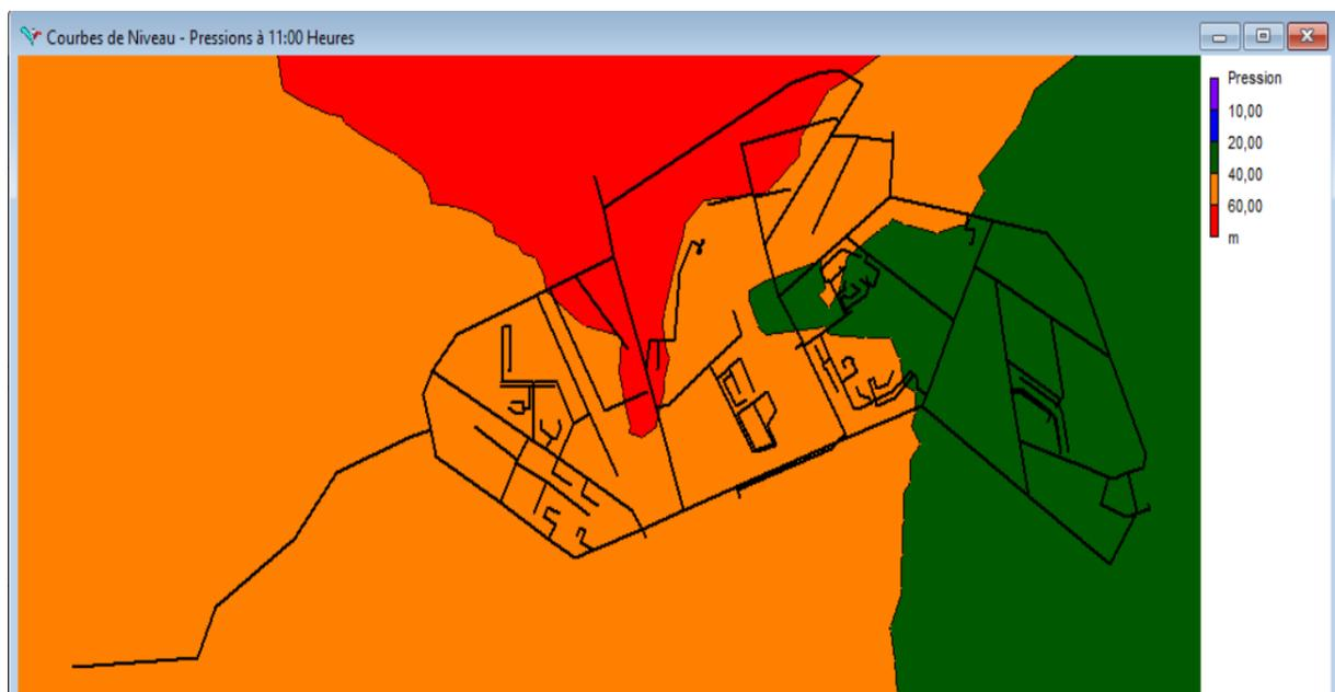
Figure.IV.9. Enveloppes de pression à 11h pour le modèle 1 de consigne 7 bar
