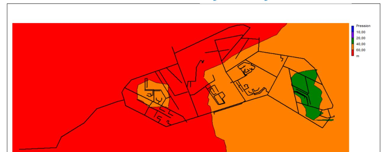
Figure.IV.4 Enveloppes de pressions suivant la consigne de 7 bar
