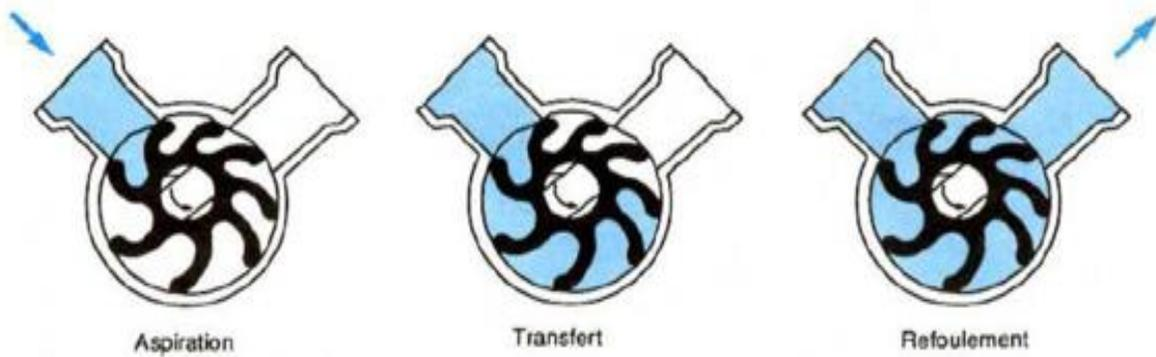
Figure 1.7 : Pompe à palettes flexibles
