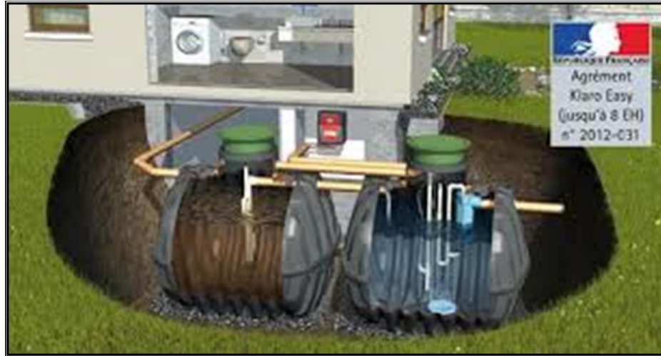
Figure.83.exemple d'une micro station d'épuration
