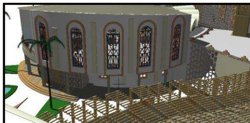
**13- Les coupoles avec fenêtres**:Elles servent à réfléchir les rayons solaires et orienter les vents dominants pour éviter les vents de sable, tout en favorisant une ventilation naturelle à travers les fenêtres placées en haut, au dessous de la coupole par effet de cheminé.
