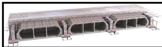
**Figure 178.** Plancher à corps creux
