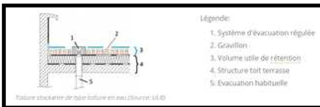
**Figure 67.**Schéma de principe d'un toit-bassin
